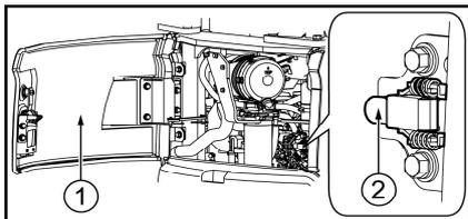
1. Ouvrez le capot moteur à l'aide de la clé de démarrage.
