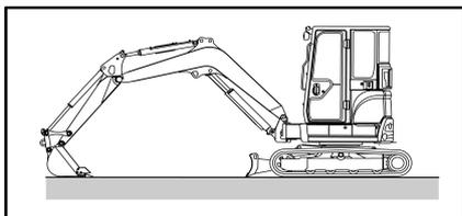
3. Abaissez le godet pour mettre sa surface inférieure en contact avec le sol.
