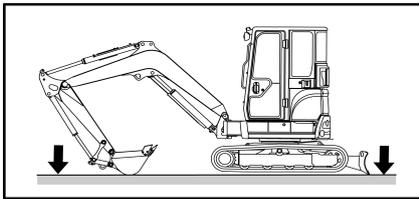
2. Soulevez la machine avec l'équipement en actionnant le levier de commande.
