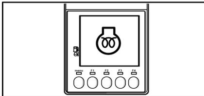
Tournez la clé sur la position ON pour allumer le circuit d'alimentation et le circuit de charge. Conservez la clé dans cette position pendant le fonctionnement du moteur.
