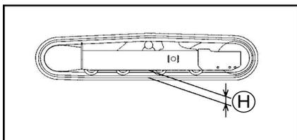
2. Vérifiez la tension. Le jeu entre la partie inférieure du châssis inférieur et la face intérieure de la machine doit être de 125 ~ 135 mm.
