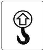
**Utilisez un moyen d'élinguage compatible avec le poids de la machine et conforme à la norme en vigueur.**
