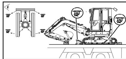
1. Vérifiez l'état du plateau du porte-engin. Si le plateau est gras, il doit être nettoyé avant d'installer la machine sur le porte-engin.
