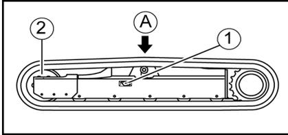
1. Déplacez la machine de sorte que la marque sur la surface intérieure de la chenille soit placée au centre du châssis supérieur.
