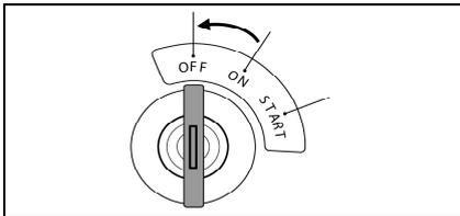
6. Tournez la clé sur la position OFF pour arrêter le moteur et couper le circuit électrique.
