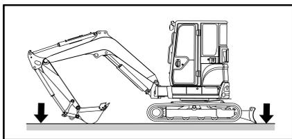
1. Soulevez la machine avec l'équipement en actionnant le levier de commande.
