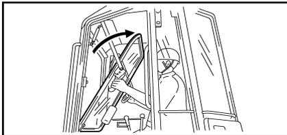
2. Remontez la partie supérieure du pare-brise et faites-la glisser vers l'arrière jusqu'à ce qu'elle vienne se loger sous le plafond.
