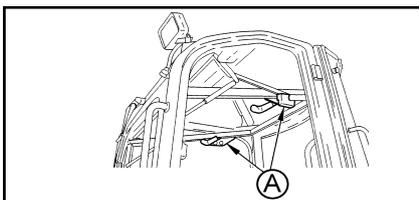
3. Verrouillez-la à l'aide du verrouillage de sécurité situé à droite et à gauche du plafond.
