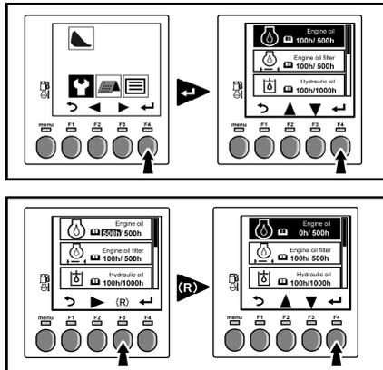
Après la réalisation de la maintenance, réinitialisez l'accumulation du temps de maintenance :
