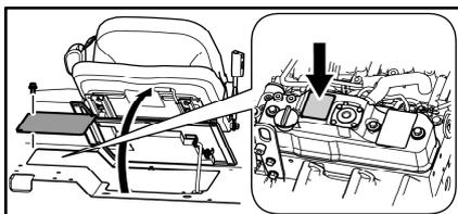
La plaque du numéro de série du moteur se trouve sur le dessus du cache culbuteur et sur l'autocollant situé à l'intérieur du capot moteur. N'enlevez jamais cette plaque pour quelque raison que ce soit.
