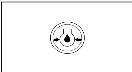
Si la pression d'huile moteur chute en-dessous du niveau normal, le témoin d'avertissement s'allume et l'avertisseur sonore retentit. Dans ce cas, arrêtez le moteur
