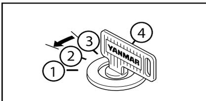
6. Tournez la clé sur la position OFF pour arrêter le moteur et couper le circuit électrique.
