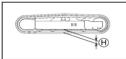
4. A l'aide de la pompe à graisse, injectez de la graisse par le graisseur pour que le jeu H se trouve entre 105 ~ 115 mm.
