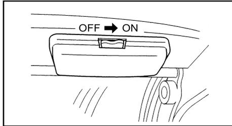
L'éclairage intérieur peut être actionné lorsque la clé de démarrage est sur la position ON.
