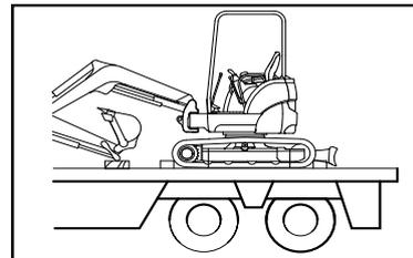
1. Vérifiez l'état du plateau du porte-engin. Si le plateau est gras, il doit être nettoyé avant d'installer la machine sur le porte-engin.
