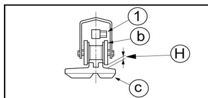
4. A l'aide de la pompe à graisse, injectez de la graisse par le graisseur pour que le jeu H se trouve entre 8 ~ 13 mm.
