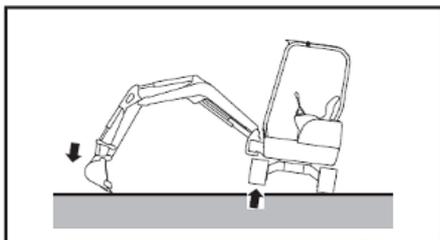
1. Soulevez la machine avec l'équipement en actionnant le levier de commande.
