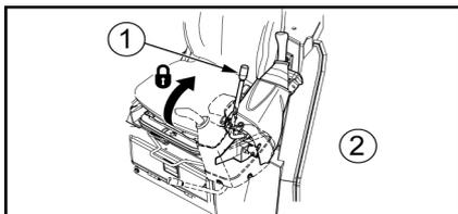
4. Verrouillez les leviers de commande avec le levier de verrouillage.
