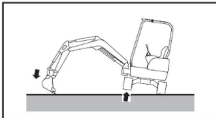
2. Soulevez la machine avec l'équipement en actionnant le levier de commande.
