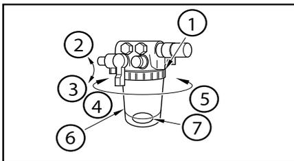
4. Desserrez la bague de serrage du bol.
