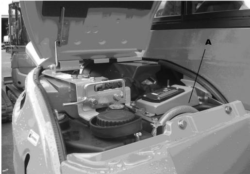
1. Ouvrez le capot **R** La pompe électrique de remplissage en carburant se trouve sous le capot droit de la machine.
