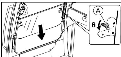
1. Poussez vers le bas les leviers de verrouillage situés à droite et à gauche du pare-brise inférieur.
