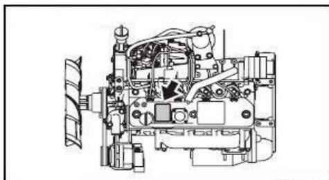
La plaque du numéro de série du moteur se trouve sur le dessus du cache culbuteur et sur l'autocollant situé à l'intérieur du capot moteur. N'enlevez jamais cette plaque pour quelque raison que ce soit.
