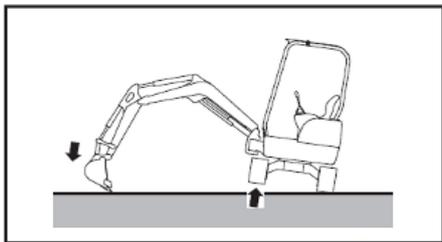
3. Soulevez la machine avec l'équipement en actionnant le levier de commande.
