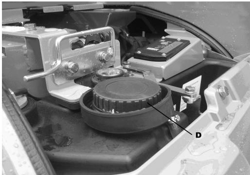
6. Ouvrez le capot B à l'aide de la clé de démarrage. Ouvrez le bouchon du réservoir à carburant. (D).
