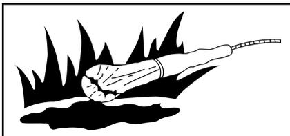
Utilisez un éclairage antidéflagrant lorsque vous vérifiez le carburant, l'huile, l'eau de refroidissement ou l'électrolyte de la batterie. Dans le cas contraire, il y a risque d'incendie et d'explosion.
