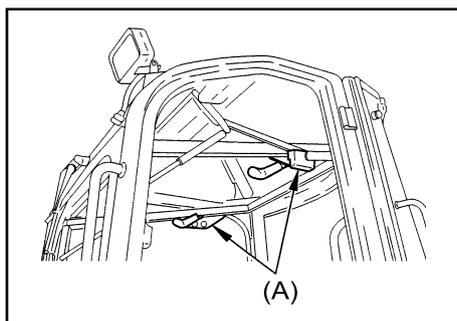
3. Verrouillez-la à l'aide du verrouillage de sécurité (A) situé à droite et à gauche du plafond.
