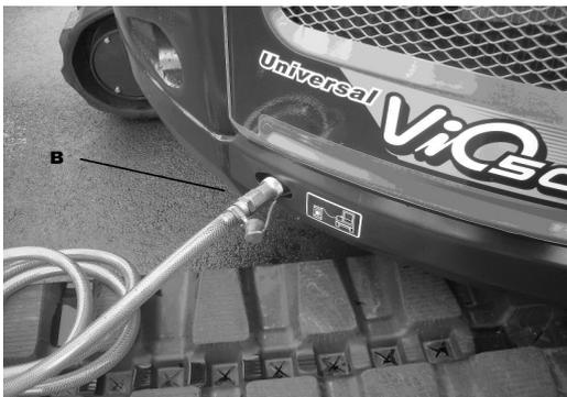
3. Connecter le tuyau sur le coupleur rapide situé sur le flanc droit de la machine (B).
