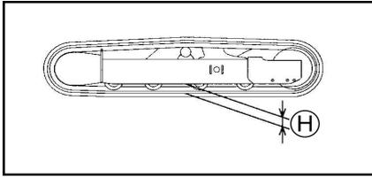
2. Vérifiez la tension. Le jeu entre la partie inférieure du châssis inférieur et la face intérieure de la machine doit être de 105 ~ 115 mm.
