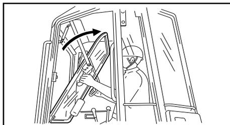
2. Remontez la partie supérieure du pare-brise et faites-la glisser vers l'arrière jusqu'à ce qu'elle vienne se loger sous le plafond.
