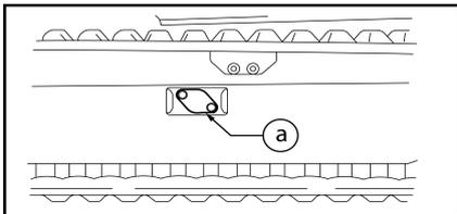
1. Dévissez les deux vis et faites pivoter le cache pour accéder au graisseur.
