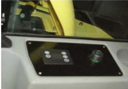
Le tableau de commande se trouve sur le tableau de bord de la machine.
