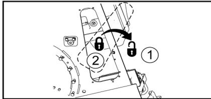
1. Faites pivoter la structure supérieure pour que le bouchon de vidange sous le réservoir à carburant se trouve du côté opposé à la lame entre les deux chenilles.
