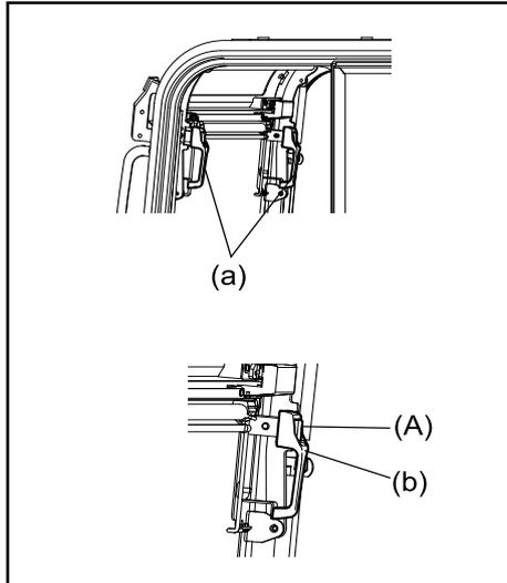
1. Saisissez les poignées (a) et appuyez sur les leviers à droite et à gauche de la fenêtre jusqu'à entendre un déclic pour qu'ils se déverrouillent.
