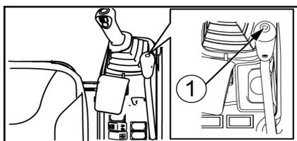
1. Pour passer en 2ème vitesse, appuyez sur l'interrupteur situé sur le levier de lame. Le témoin de 2ème vitesse s'allume sur le moniteur LCD.
