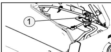
Cet interrupteur permet de couper directement la batterie.
