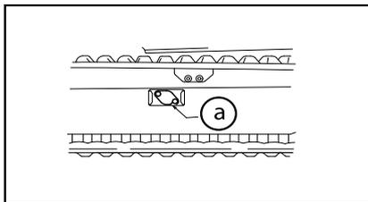
1. Dévissez les deux vis et faites pivoter le cache pour accéder au graisseur.
