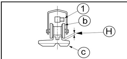
3. Vérifiez la tension. Le jeu H entre la surface de roulement externe du second rouleau de chenilles du galet-tendeur et la surface interne de la chenille doit être de 8 ~ 13 mm.
