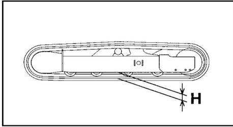
2. Vérifiez la tension. Le jeu entre la partie inférieure du châssis inférieur et la face intérieure de la machine doit être de 105 ~ 115 mm.
