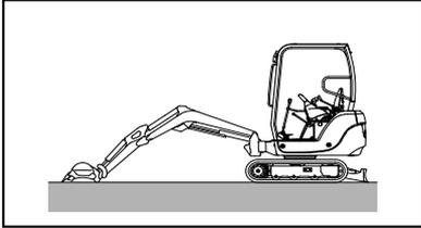
1. Mettez la machine dans la position illustrée ci-contre : lame en arrière et abaissée au sol, équipement parallèle aux chenilles, vérin de la flèche à moitié sorti, vérin du bras rétracté jusqu'à l'extrémité de sa course, dents du godet au sol.
