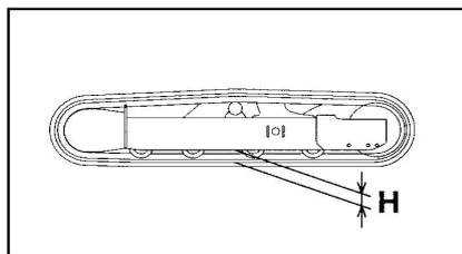
4. A l'aide de la pompe à graisse, injectez de la graisse par le graisseur pour que le jeu H se trouve entre 105 ~ 115 mm.
