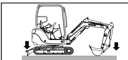
3. Soulevez la machine avec l'équipement en actionnant le levier de commande.
