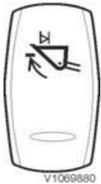
Basculement automatique (automatique de godet)
