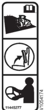
27 Sur la voie publique, il est interdit d'activer la direction par leviers (CDC) ; utilisez le volant de direction.
