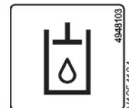
20 Point de remplissage du liquide hydraulique
