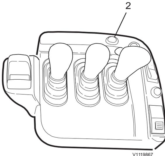
2 Freinage moteur/rétrogradation
