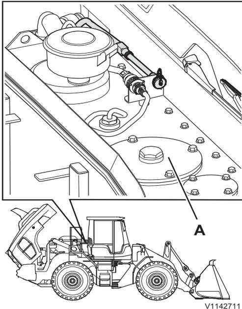
Point de remplissage du liquide hydraulique
