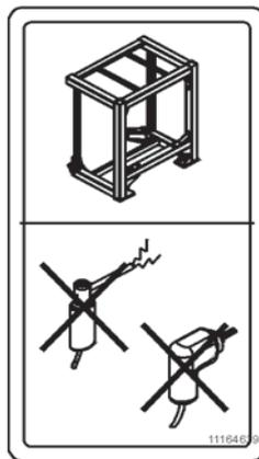
34 Soudage et/ou perçage interdit dans la cabine
