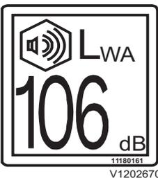
10 Niveau de puissance acoustique à l'extérieur de la machine
