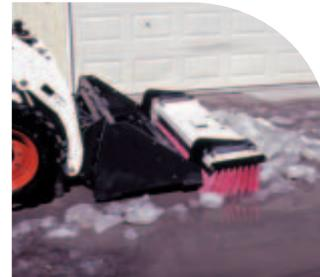
Combiné aux balayeuses, le kit d'arrosage permet de rabattre la poussière (idéal également pour les raboteuses, les rouleaux vibrants, les balayeuses orientables, etc.). Une pompe électrique alimente la rampe d'arrosage de l'accessoire.
