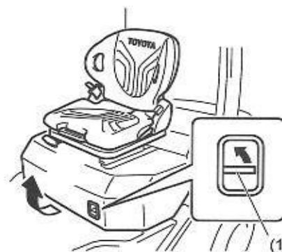
(1) Levier de déverrouillage du capot
