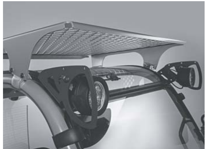
Protection complémentaire contre les chutes d'objets
