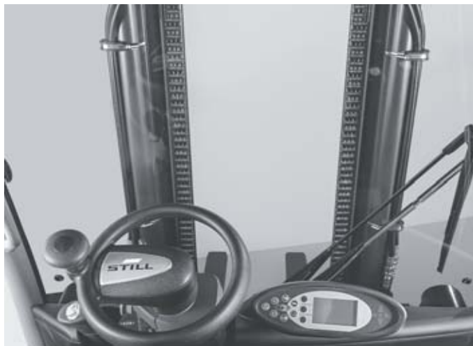
Vue dégagée avec le mât télescopique
