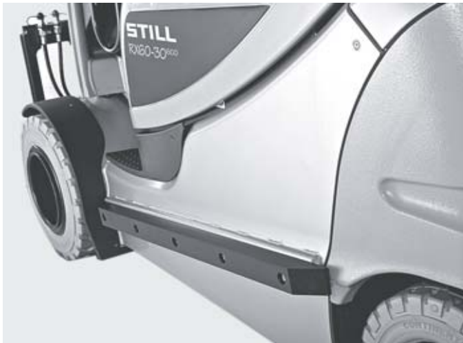
Protection latérale pour les utilisations particulièrement difficiles
