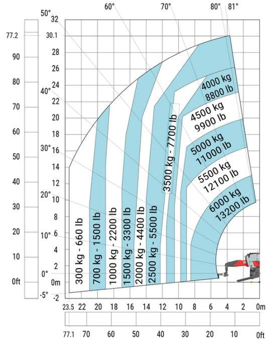
Machine sur stabilisateurs abaissés avec potence-treuil de 2000 kg (Métric)
