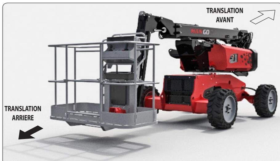
Mode travail: Un ou plusieurs bras de la nacelle sont levés et / ou le télescope est sorti. Dans ce mode, les translations se font en petite vitesse, les sécurités pour le dévers et la surcharge sont actives.
