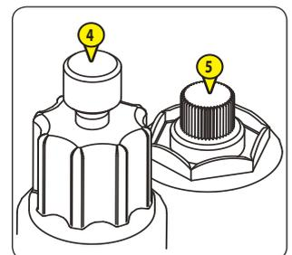
*Pour mettre les valves du distributeur au "neutre", tourner dans le sens anti-horaire la valve 4 et dans le sens horaire la valve 5.*
