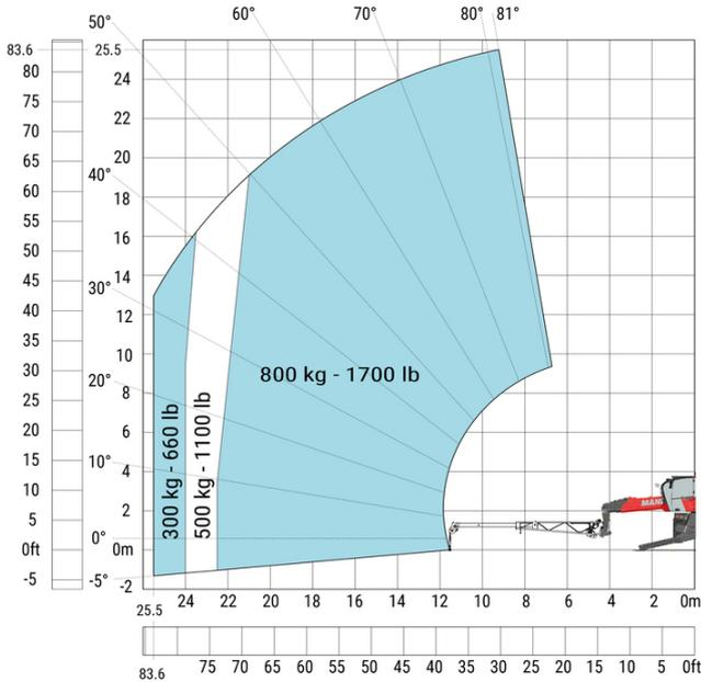
Machine sur stabilisateurs abaissés avec crochet 6000 kg (Métrique)
