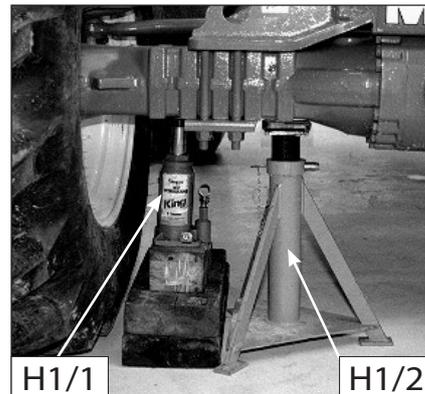
Pour effectuer cette opération, il est conseillé d'utiliser un cric hydraulique et le support de sécurité.
