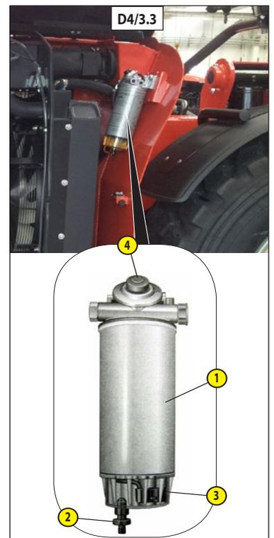
Ouvrir le robinet de vidange et la vis de purge 2 (D4/4) en récupérant le mélange eau-carburant qui sort de l'élément filtrant dans un récipient.
