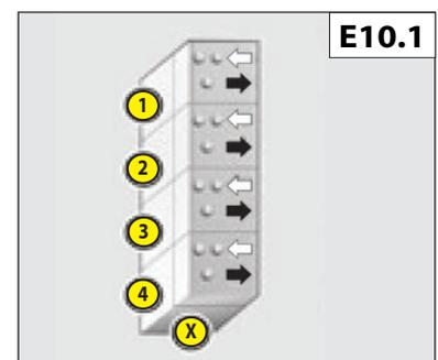
Tourner le vilebrequin avec le dispositif de virage, jusqu'à ce que le 4e cylindre se trouve au PMH de chevauchement (1er cylindre au PMH d'allumage). Régler ensuite le 1er cylindre au PMH de chevauchement (4e cylindre au PMH d'allumage).
