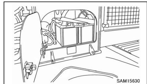
2. Retirez le câble (2) de la borne négative (-) (prise de terre) sur la batterie de droite.
