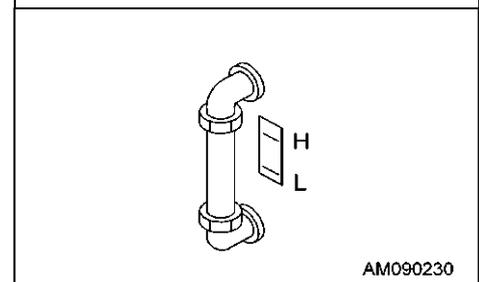
6. Si le niveau de l'huile est inférieur à la ligne L, rajoutez de l'huile par l'orifice de remplissage (2).
