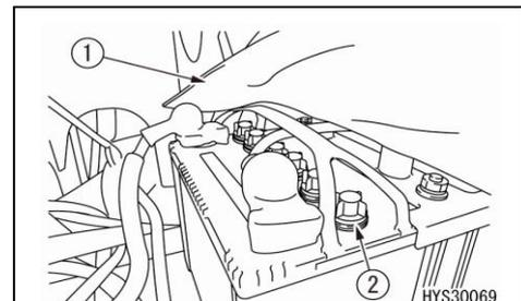
3. Si l'électrolyte n'atteint pas le tube (4), rajoutez de l'eau distillée jusqu'à ce qu'elle atteigne le bas du tube (ligne de niveau supérieur).
