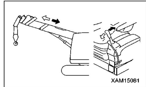
8. Actionnez lentement le levier de contrôle des équipements de travail gauche (4) du côté « rétraction » (tirez vers l'arrière). Actionnez le levier jusqu'à la butée et maintenez-le en position pendant 30 secondes.
