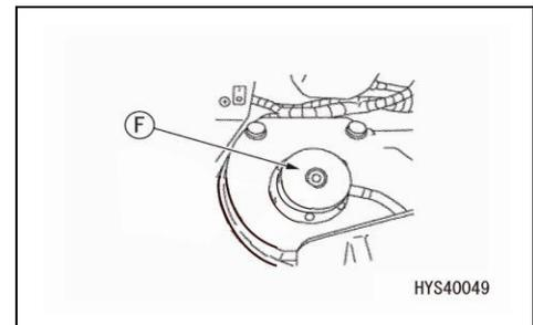
6. Mettez une cuve pour récupérer l'huile sous le bouchon de drainage sous le châssis de la machine.
