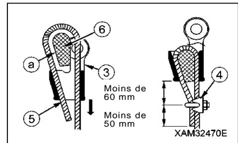
7. Attachez le clip du câble (4) au câble métallique (5) conformément aux dimensions spécifiées sur le schéma de droite.
