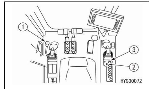
1. Vérifiez que le levier de verrouillage (1) se trouve en position verrouillée (L). Si le levier de verrouillage (1) se trouve en position libre (F), le moteur ne démarre pas.
