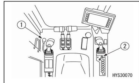
1. Vérifiez que le levier de verrouillage (1) se trouve en position verrouillée (L).
