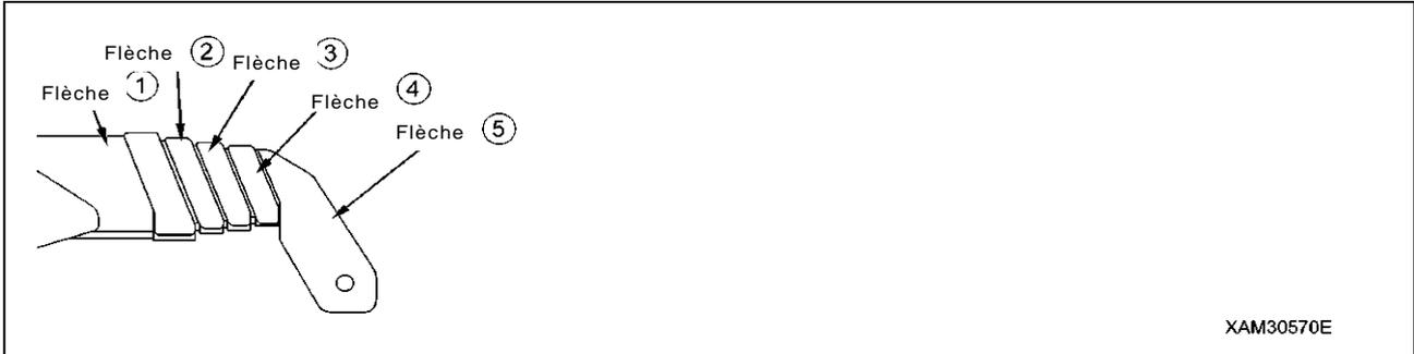
2. « Flèche 7,625 m (2) » : Les flèches (3), (4) et (5) sont rétractées, la flèche (2) est entièrement étendue.
