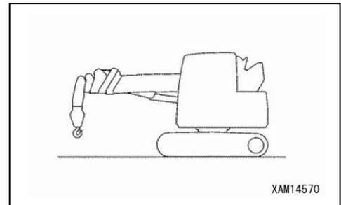
2. Faites pivoter la structure supérieure pour positionner le bouchon de drainage qui se situe sous le réservoir d'huile hydraulique entre les chenilles.
