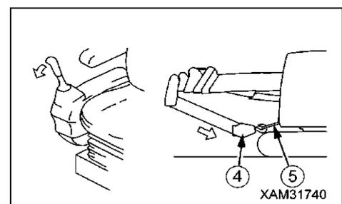
4. Actionnez le levier de contrôle des équipements de travail droit (3) en position « LEVAGE DE LA FLÈCHE » (tirez vers vous), levez la flèche.
