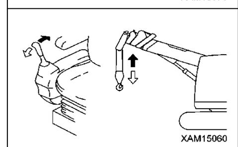
En même temps, actionnez le levier de contrôle des équipements de travail droit (3) en position « abaissement du crochet » (poussez vers l'avant) et abaissez le crochet de façon à éviter la situation d'enroulement excessif.
