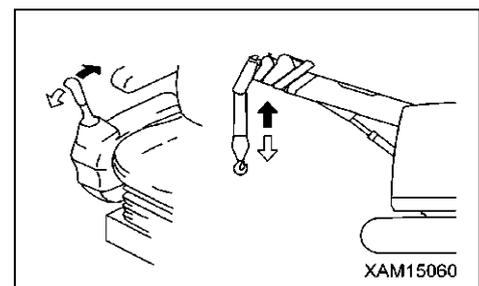
Ensuite, actionnez le levier de contrôle des équipements de travail droit en position « abaissement du crochet » (poussez vers l'avant), afin d'abaisser le moufle à crochet.
