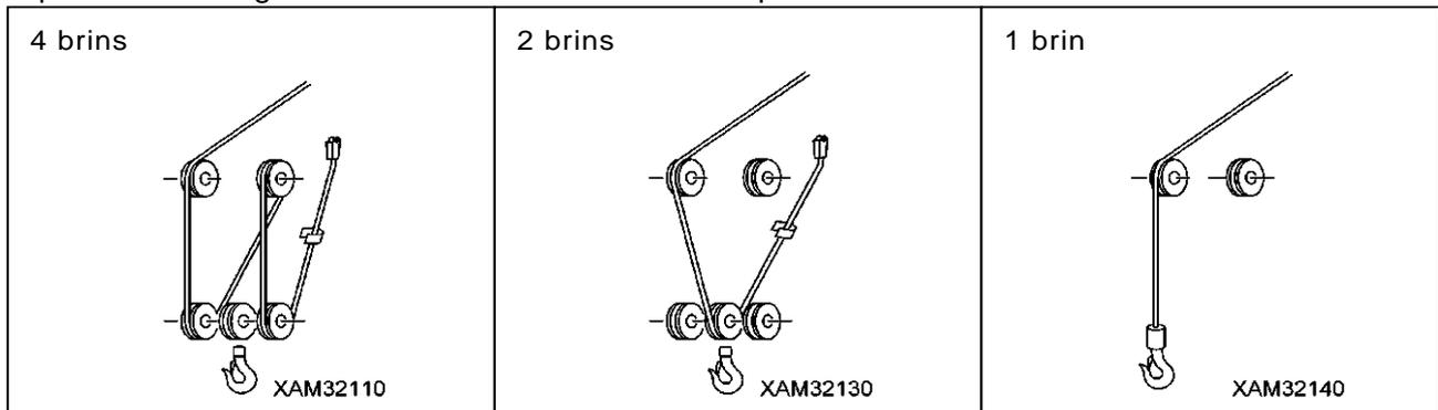
5. Faites passer l'extrémité du câble métallique (5) par le poids du détecteur de levage excessif.
