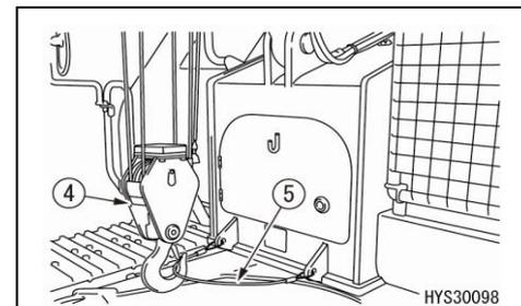
7. Bloquez correctement le câble métallique d'arrimage du moufle à crochet (5) sur l'accroche de câble (6).
