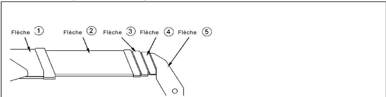
3. « Flèche 10,505 m (3) » : Les flèches (4) et (5) sont rétractées, les flèches (2) et (3) sont entièrement étendues.
