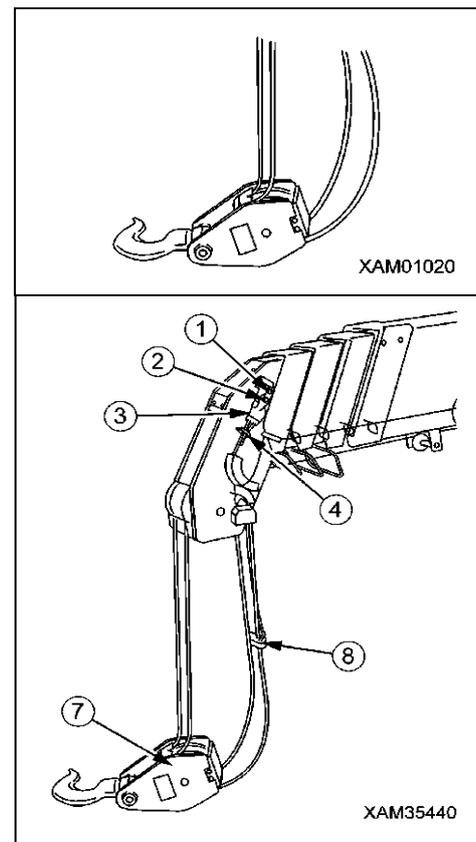
6. Retirez correctement le câble métallique (5) de l'attache à clavette (3), de la façon suivante :
