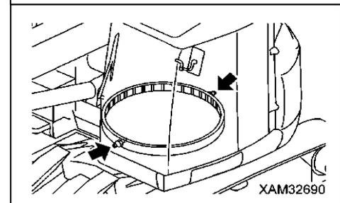
**[4] NETTOYAGE / VÉRIFICATION DES ARMATURES DU RADIATEUR, DES ARMATURES DU SYSTÈME DE REFROIDISSEMENT D'HUILE ET DES ARMATURES DU SYSTÈME D'AIR CONDITIONNÉ**
