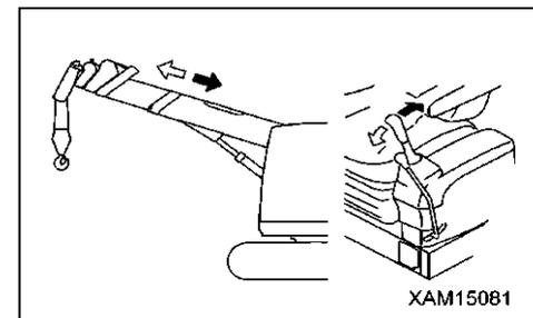
2. Actionnez le levier de contrôle des équipements de travail droit (2) en position « levage de la flèche » (tirez vers l'intérieur) et élevez la flèche jusqu'à ce que le moufle à crochet atteigne presque la position d'arrimage normale.
