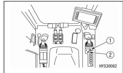
2. Mettez le commutateur de démarrage (1) en position ARRÊT pour stopper le moteur.
