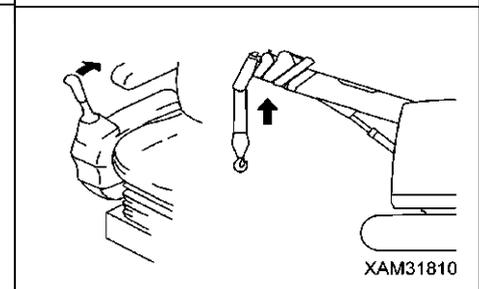
2. Actionnez le levier de contrôle des équipements de travail droit (1) en position « ABAISSEMENT DE LA FLÈCHE » (poussez vers la droite), afin d'abaisser la flèche (4).
