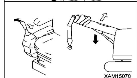
En même temps, actionnez le levier de contrôle des équipements de travail droit (3) en position « levage du crochet » (tirez vers l'arrière) et levez le crochet de façon à ce qu'il ne touche pas le sol.
