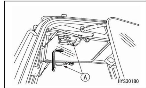
5. Lorsque le bas de la fenêtre atteint le haut de la fenêtre inférieure, poussez le haut de la fenêtre inférieure vers l'avant pour l'appuyer contre les accroches de verrouillage gauche et droit (E) et engagez le verrouillage.
