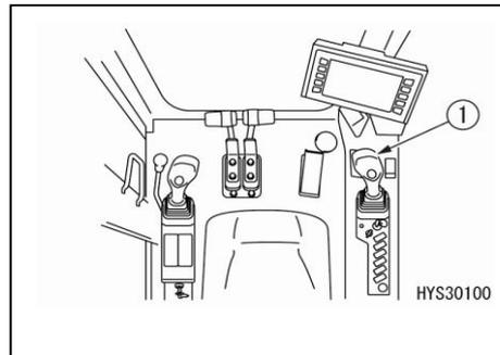
1. Actionnez le levier de contrôle des équipements de travail droit (1) en position « LEVAGE DU CROCHET » (tirez vers l'arrière), afin de lever le moufle à crochet.
