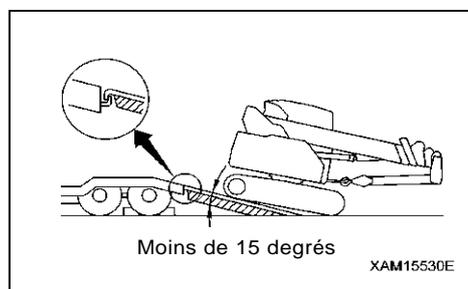
Mettez toujours la machine en « position de déplacement » pour procéder au chargement / déchargement. Veillez à toujours utiliser une rampe ou une plate-forme de levage pour le chargement / déchargement de la machine, et respectez la procédure suivante :
