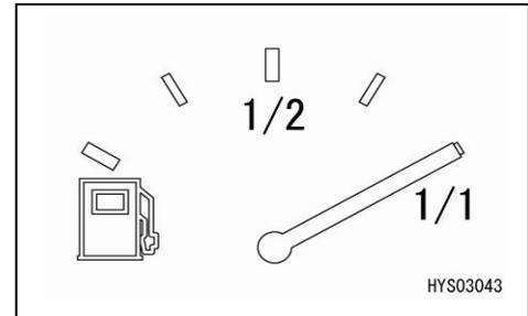
3. Si le niveau de carburant se trouve être bas, dévissez le bouchon de l'orifice de remplissage (F) sur le réservoir de carburant et versez du carburant jusqu'à ce que la jauge flottante (G) soit proche du point supérieur.
