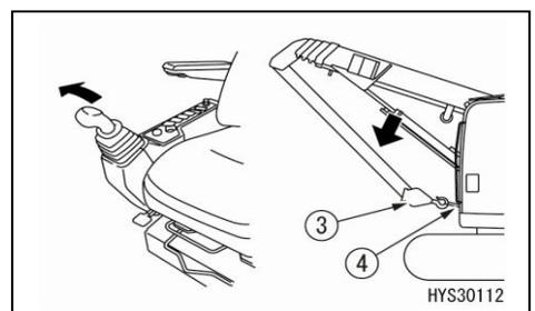
7. Actionnez le levier de contrôle des équipements de travail droit (2) en position « levage du crochet » (tirez vers l'arrière) et élevez le moufle à crochet pour exercer une tension suffisante sur le câble métallique d'arrimage (5).
