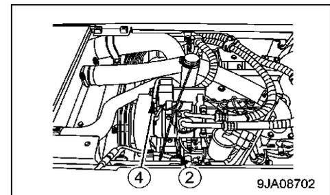
2. Desserrez l'écrou (5) attaché à l'accroche (3) puis serrez le boulon (6). Serrez le boulon (6) de façon à ce que la flexion de la courroie soit comprise entre 5 et 8 mm (environ 58,8 N (6 kg)).
