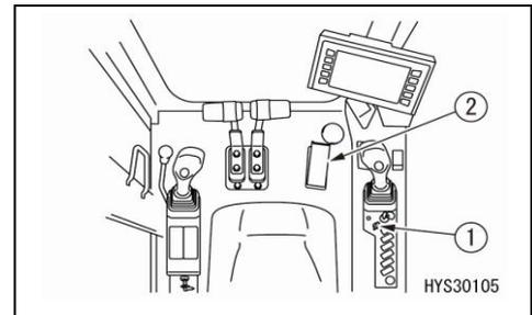
Utilisez en même temps le bouton de contrôle de l'alimentation en carburant (1) et la pédale d'accélération (2) pour un contrôle adapté de la vitesse de travail.
