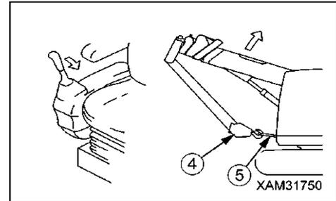
5. Répétez les actions des points 4 et 5, afin que la flèche soit lentement levée à la position où le moufle à crochet (4) vient perpendiculairement à sa position d'arrimage à l'avant de la structure supérieure de la grue.
