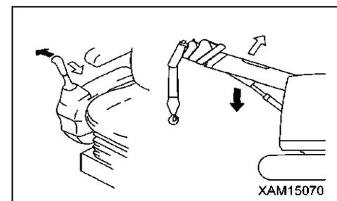
3. Actionnez le levier de contrôle des équipements de travail droit (2) en position « abaissement du crochet » (poussez vers l'avant) et abaissez le moufle à crochet jusqu'à ce qu'il atteigne presque la position d'arrimage normale.
