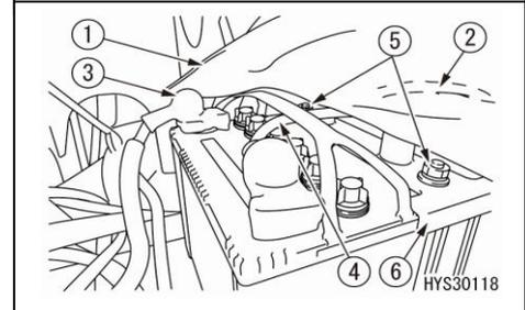
5. Retirez les boulons de montage (5) sur les deux emplacements, puis retirez la pièce de maintien (6) et le couvercle en vinyle (1).
