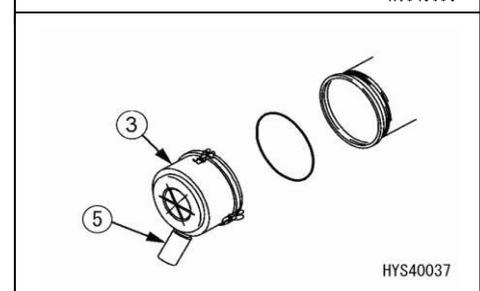
5. Vérifiez la valve d'évacuation (5), une obstruction pouvant l'endommager.
