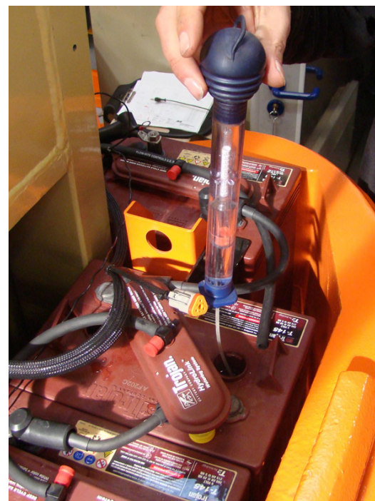
Figure 5-8. Mesure de la Densité de l'Electrolyte
