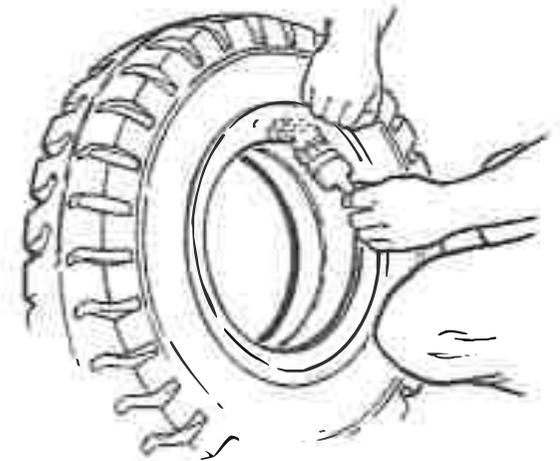
**REMARQUE:** Si la jante de roue est large de moins de six pouces, le TBS comporte un orifice de valve s'adaptant à la valve à aiguille. Si la jante de roue est large de plus de six pouces, le TBS comporte deux orifices de valve s'adaptant à la valve à aiguille.
