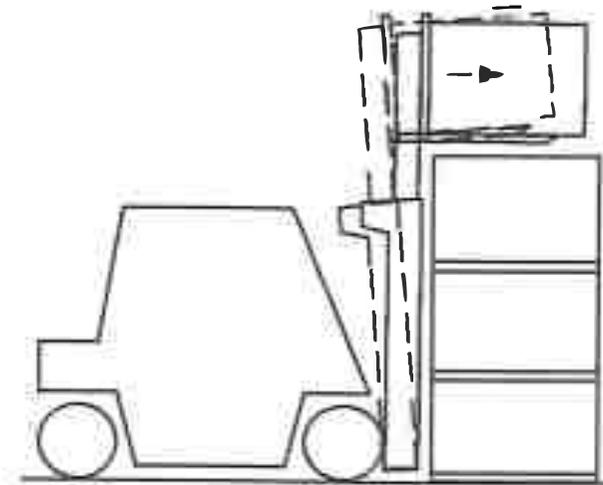
**SI LE CHARIOT ELEVATEUR BASCULE SUR LE COTE OU VERS L'AVANT, NE SAUTEZ PAS ! TENEZ FERMEMENT LE VOLANT,**
