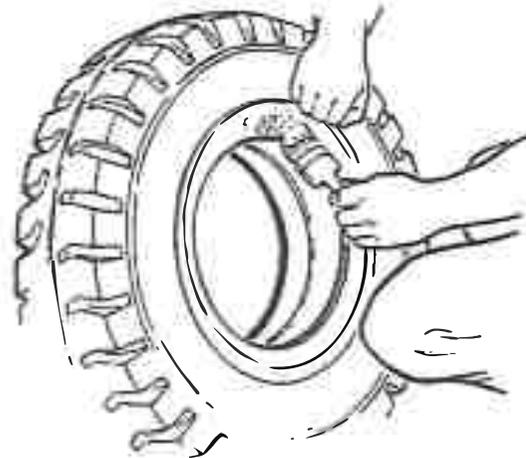
2. Placez la jante sur le plateau de la presse. Placez le pneu sur la jante. Positionnez la cage sur le pneu. Utilisez la presse pour installer le pneu sur la jante.
