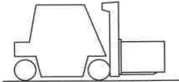
2. Avancez lentement jusqu'à ce que les fourches soient en position sous la charge. Les fourches doivent supporter au moins les deux tiers (2/3) de la longueur de la charge.
