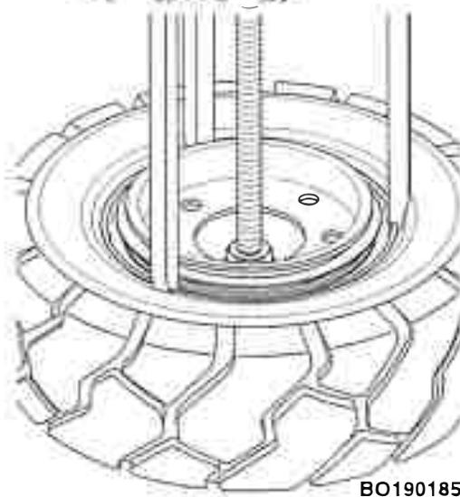
3. Retirez l'anneau de blocage du bord libre et la bande d'avance (roue en quatre pièces uniquement) avec un démonte pneu.
