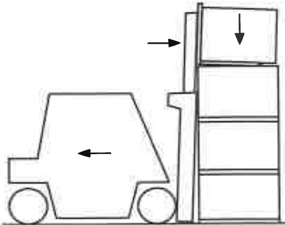
Avancez lentement. Lorsque la charge est en position pour être déposée, abaissez la charge sur la pile ou le rayonnage. Abaissez les fourches juste assez pour pouvoir les dégager de la charge. N'abaissez pas trop les fourches pour qu'elles ne raclent pas la surface sous la charge. Inclinez le mât en avant juste ce qu'il faut pour permettre le retrait en douceur des fourches de sous la charge. Reculez doucement pour retirer les fourches de la charge. Abaissez les fourches lors des déplacements.
