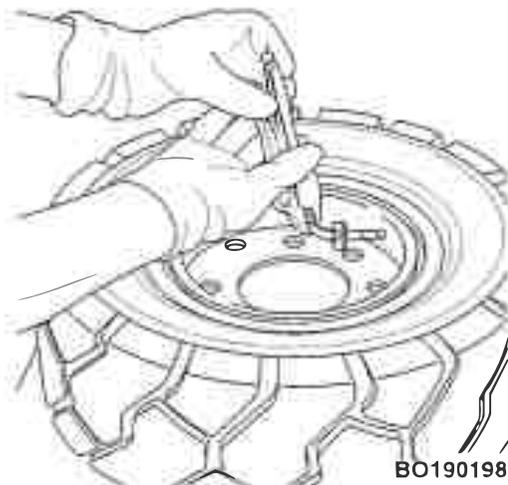
2. Placez la roue et le pneu sur la presse. Positionnez les pieds de la presse sur le bord libre. Enfoncez le bord libre pour exposer l'anneau de blocage.
