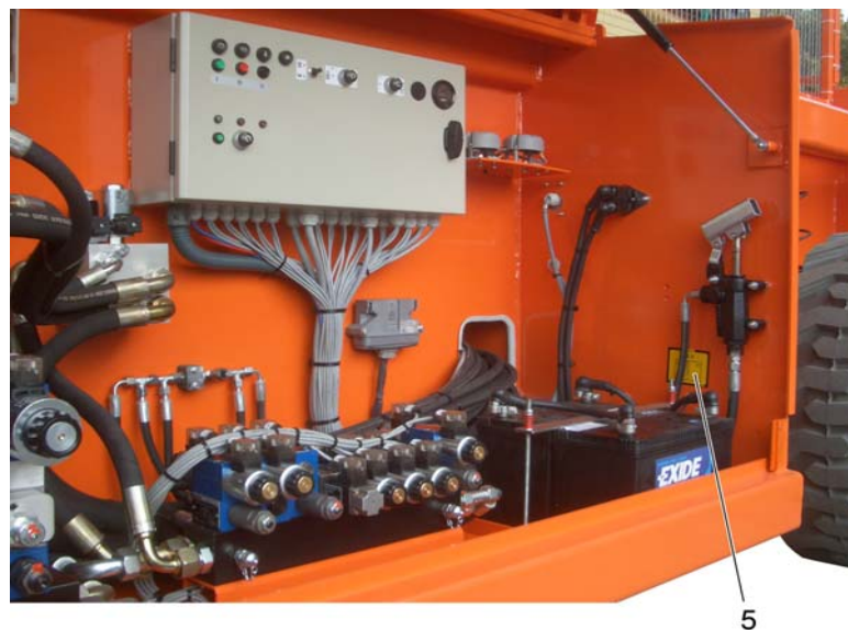
Compartiment des soupapes et compartiment électrique
