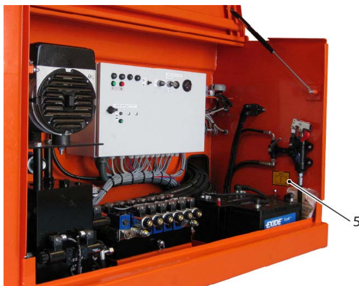
Compartiment des soupapes et compartiment électrique
