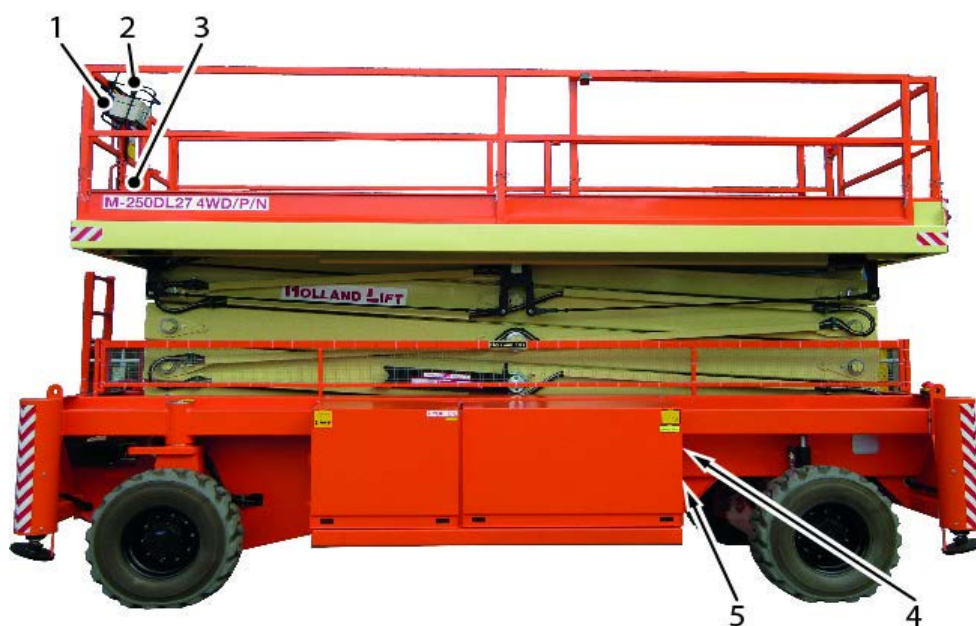
Vue d'ensemble des organes de commande
