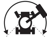
Remarque : lorsque le système de validation de translation est utilisé, il est possible que la machine se déplace dans le sens opposé à celui dans lequel la manette de contrôle de translation/direction est déplacée.
