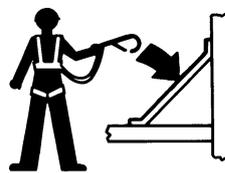
Les occupants de la nacelle doivent porter une sangle ou un harnais de sécurité et se conformer aux réglementations officielles en vigueur. Attacher la longe de sécurité au point d'ancrage prévu à cet effet dans la nacelle.
