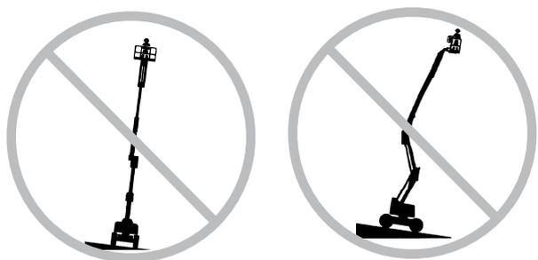
Ne pas se fier à l'alarme de dévers pour indiquer le niveau. L'alarme de dévers retentit dans la nacelle uniquement lorsque la machine se trouve sur une pente à forte inclinaison.
