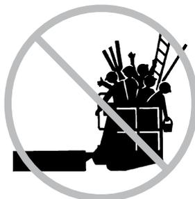
Ne pas placer d'échelle ni d'échafaudage dans la nacelle, ni contre une partie de la machine.
