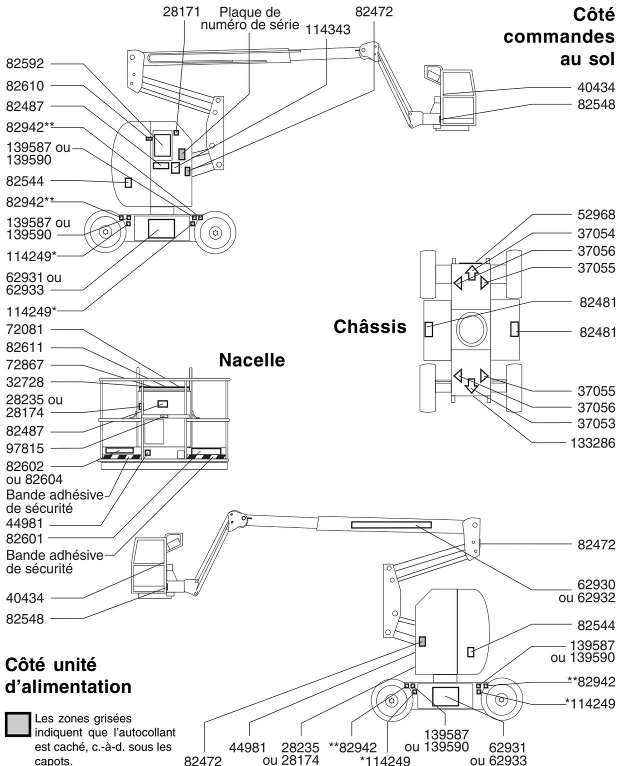
Les zones grisées indiquent que l'autocollant est caché, c.-à-d. sous les capots.
