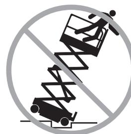
Ne pas se fier à l'alarme de dévers pour indiquer le niveau. L'alarme de dévers retentit sur le châssis uniquement lorsque la machine se trouve sur une pente à forte inclinaison.
