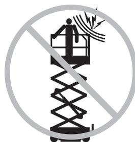
Restez éloigné de la machine si elle touche des lignes sous tension. Le personnel au sol ou à bord de la nacelle ne doit l'ini toucher, ni utiliser la machine tant que les lignes électriques sont sous tension.
