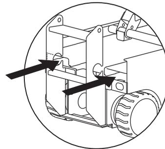
Placer les fourches des chariots élévateurs en position sur les entrées de fourche.
