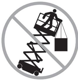
Ne pas placer ni attacher de charges fixes ou suspendues sur une partie de cette machine.
