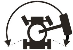
Remarque : lorsque le système de validation de translation est utilisé, il est possible que la machine se déplace dans le sens opposé à celui dans lequel la manette de contrôle de translation/direction est déplacée.
