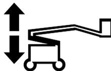
3 Interrupteur de mise à niveau de la nacelle
