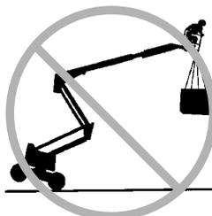
Ne pas fixer ni suspendre de charge à un élément de la machine.
