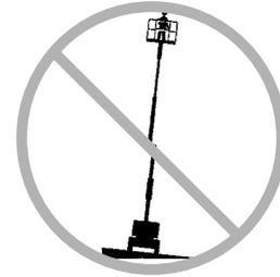
Ne pas se fier à l'alarme de dévers pour indiquer le niveau. L'alarme de dévers retentit dans la nacelle uniquement lorsque la machine se trouve sur une pente à forte inclinaison.
