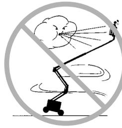
Ne pas relever la flèche lorsque la vitesse du vent est susceptible de dépasser 12,5 m/s. Si la vitesse du vent est supérieure à 12,5 m/s alors que la flèche est relevée, abaisser la flèche et arrêter toute utilisation de la machine.
