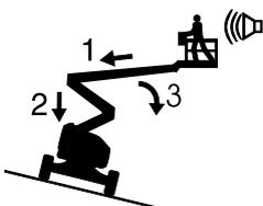
Si l'alarme de dévers retentit avec la nacelle relevée en descente :
