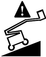
Si l'alarme de dévers retentit avec la nacelle relevée, le témoin de machine inclinée s'allume et la fonction de translation n'est pas active dans une ou les deux directions. Déterminer la position de la flèche sur la pente, comme illustré ci-dessous.
