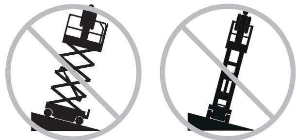
Ne pas se fier à l'alarme de dévers pour indiquer le niveau. L'alarme de dévers retentit sur le châssis et dans la nacelle lorsque la machine se trouve sur une pente.
