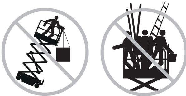
Ne pas placer d'échelle ni d'échafaudage dans la nacelle, ni contre une partie de la machine.
