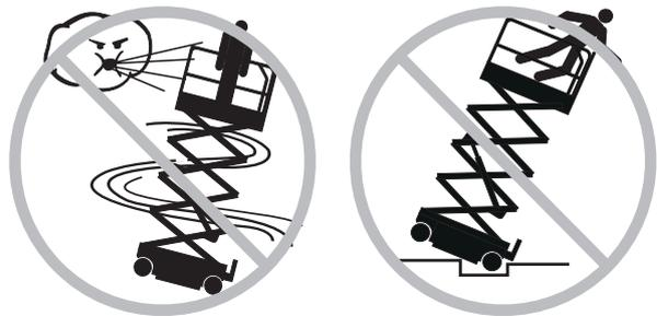
Ne pas conduire la machine avec la nacelle levée sur un terrain accidenté, un revêtement instable ou autres situations à risque.
