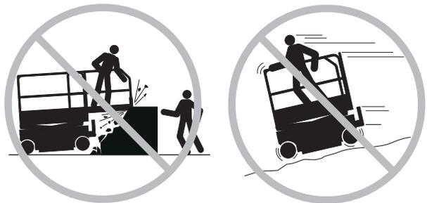
Adapter la vitesse de déplacement en fonction de l'état du sol, de la circulation, de l'inclinaison, de l'emplacement du personnel et de tout autre facteur susceptible de provoquer une collision.
