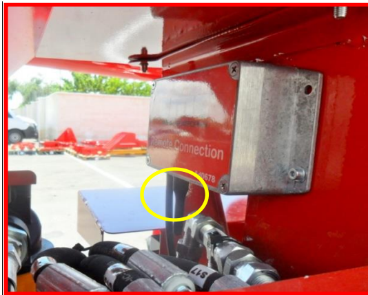
Figure 94 : Boîtier de connexion à distance.
