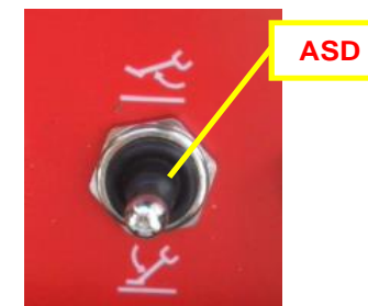
Figure 26 : sélecteur stabilisation/déstabilisation automatique sur radiocommande.
