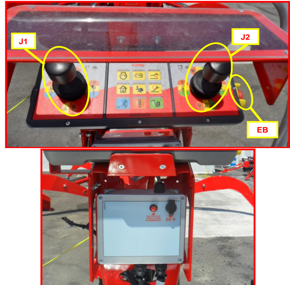
Figure 9 : poste de commande plateforme dans nacelle.
