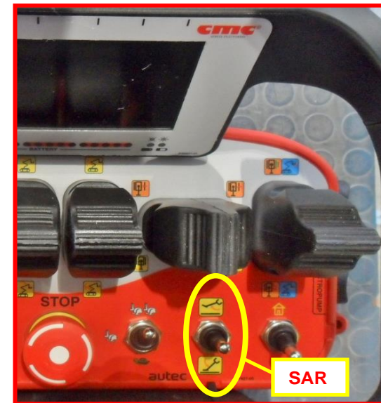
Figure 48 : sélecteur stabilisation/déstabilisation automatique sur radiocommande.
