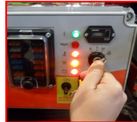
Figure 5 : phase de chauffage des bougies du moteur.
