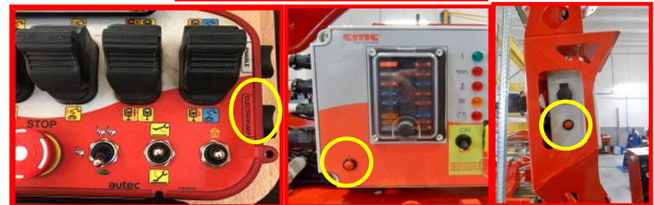
Figure 62 : activation de l'électropompe (*en option).
