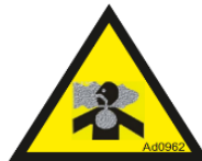
Figure 88 : risque de gaz d'échappement.
