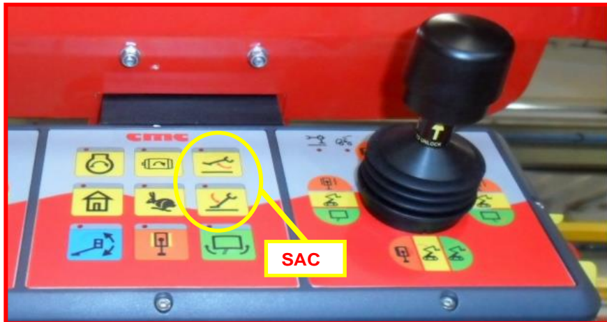
Figure 49 : boutons stabilisation/déstabilisation automatique sur console de la nacelle.
