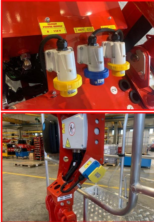
Figure 7b: prises électriques pour double alimentation.
