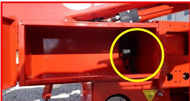
Figure 10 : chargement de la pile de radiocommande.
