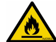
Figure 55 : danger de substances inflammables.
