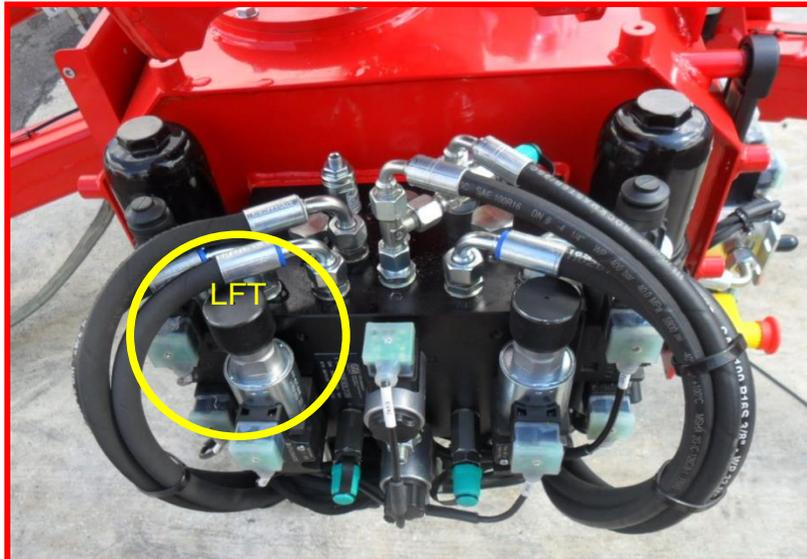
Figure 22 : vanne gauche du banc de filtres.
