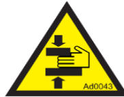
Figure 77 : danger d'écrasement et de cisaillement.
