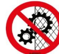
Figure 52 : interdiction de retirer les dispositifs de sécurité.
