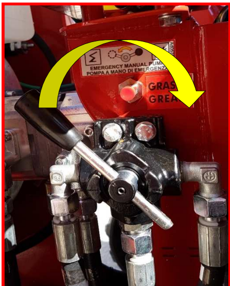
Figure 25 : robinet de la pompe manuelle en position récupération des stabilisateurs.
