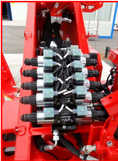
Figure 15 : banc vanne poste d'urgence.
