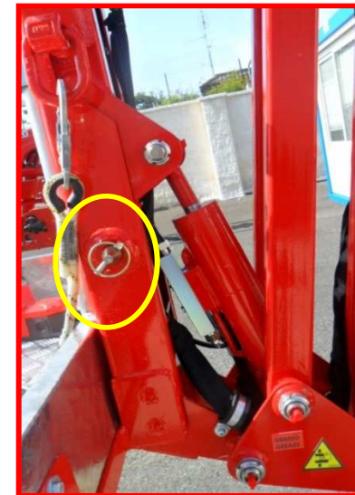
Figure 16 : assemblage de la nacelle.
