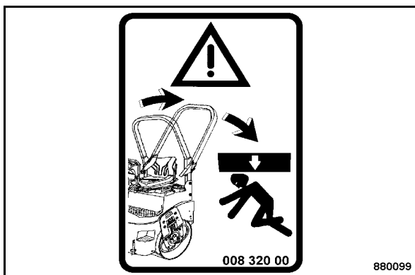
Fig. 10 Plaque d'avertissement - Arceau de sécurité ROPS rabattable 1
