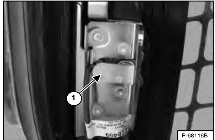
La porte de cabine est équipée d'un capteur (1) [Figure 184] qui désactive les fonctions de levage et de cavage lorsque la porte est ouverte.
