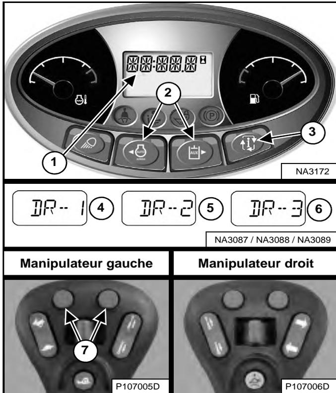
Appuyez sur le bouton « Information » (3) pour faire défiler l'affichage des données jusqu'à ce que le menu de la réaction d'entraînement s'affiche. Le réglage actuel de la réaction d'entraînement apparaît sur l'affichage des données (1) [Figure 68].
