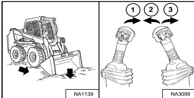
Abaissez complètement les bras de levage (1). Placez le bord d'attaque du godet sur le sol (3) [Figure 154].
