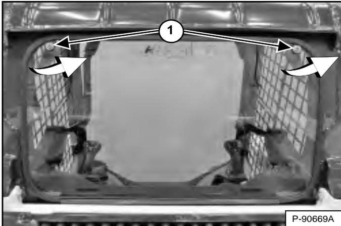
La vitre arrière peut être retirée depuis l'extérieur de la chargeuse à l'aide d'un tournevis T40 TORX®. Tournez chaque vis (1) [Figure 45] dans le sens anti-horaire jusqu'à ce que les loquets se dégagent du cadre de la vitre. Tirez le haut de la vitre vers l'extérieur et soulevez la vitre pour la retirer.
