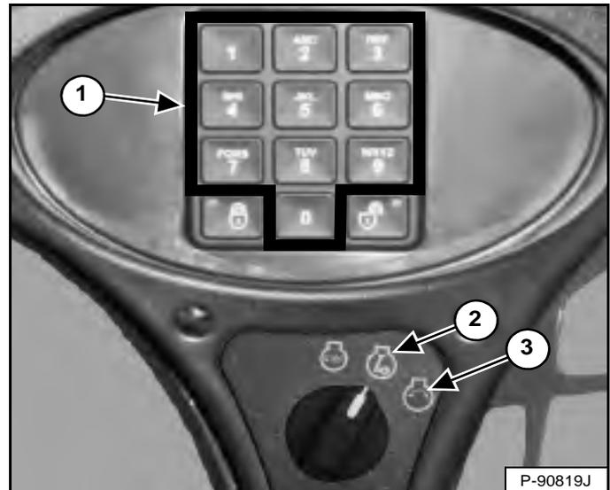
Tournez le contacteur à clé sur la position RUN (Marche) (2) [Figure 109]. Les témoins du tableau de bord gauche s'ALLUMENT brièvement tandis que le tableau de bord/système de surveillance exécute un test automatique.
