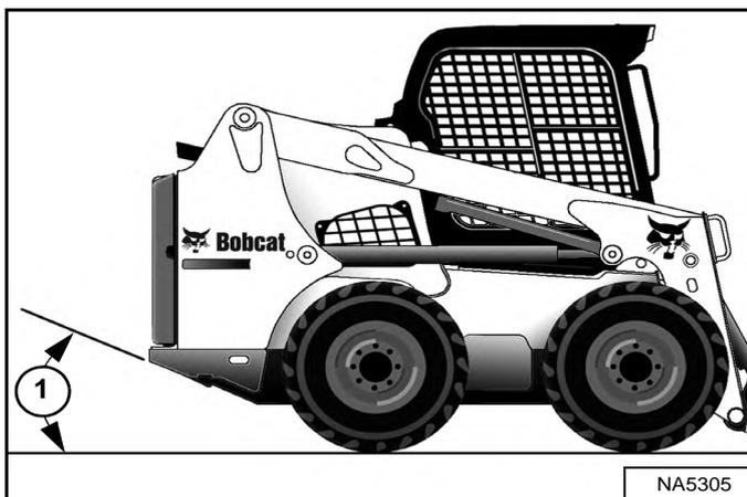
**REMARQUE :** la chargeuse doit être levée autant que possible à l'horizontale, mais l'angle de la chargeuse suspendue ne doit en aucun cas dépasser l'angle de dégagement (1) [Figure 165] indiqué dans les caractéristiques techniques (voir Dimensions en page 217).
