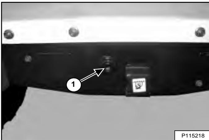
Déposez le bouchon de contrôle (1) [Figure 264] de l'avant du carter de chaînes (les bras de levage sont représentés levés pour plus de clarté).
