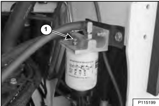
Ouvrez le purgeur d'air (1) [Figure 214] sur la base du filtre à carburant.
