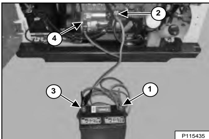
Raccordez une extrémité du premier câble (1) à la borne positive (+) de la batterie d'appoint. Raccordez l'autre extrémité de ce câble (2) [Figure 237] à la borne positive (+) du démarreur du moteur.
