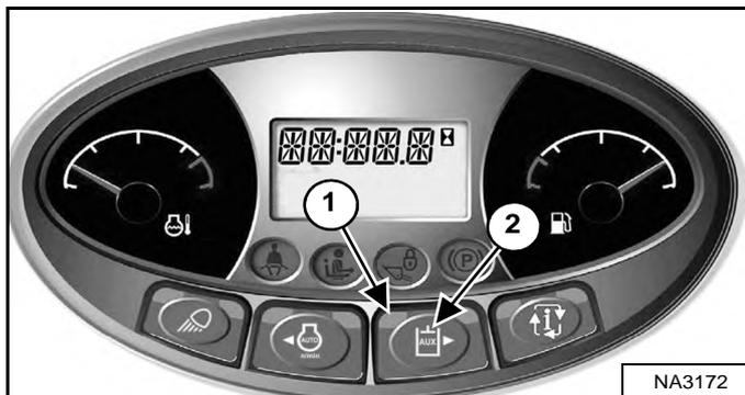
Appuyez une fois sur le bouton du circuit hydraulique auxiliaire (2) [Figure 82] pour l'activer.
