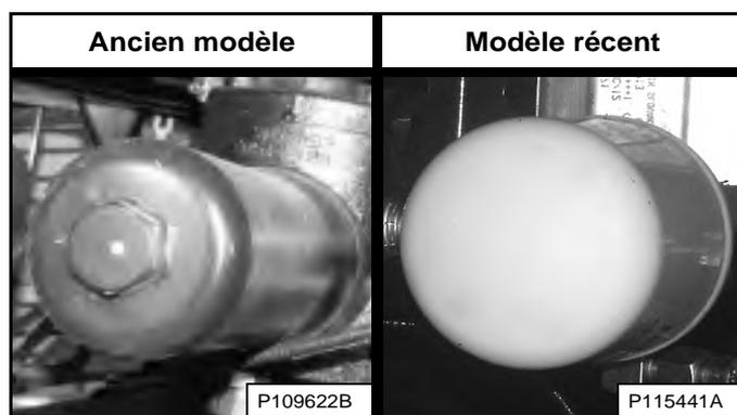
Les anciens modèles emploient un logement de filtre et un élément de filtre séparés. Les modèles récents emploient un filtre à visser **[Figure 254]**. (voir Anciens modèles en page 182) ou (voir Modèles récents en page 183)
