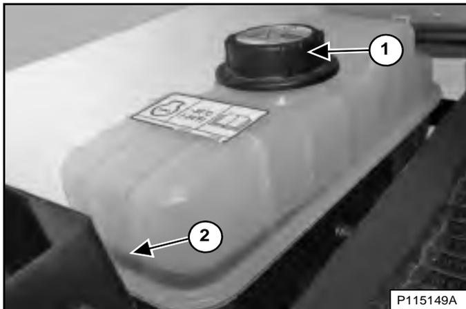
Le niveau du liquide de refroidissement doit être entre les deux repères Mini et Maxi (2) [Figure 227] lorsque le moteur est froid.
