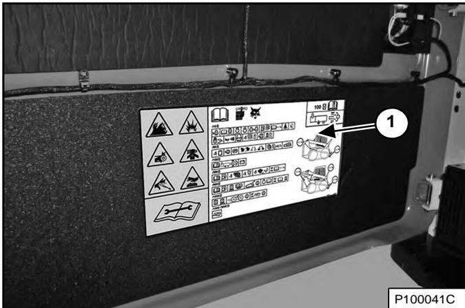
Le tableau d'entretien et la liste de contrôle (1) [Figure 92] sont situés dans la porte arrière de la chargeuse.
