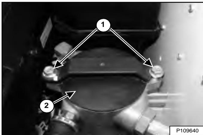
Desserrez les boulons (1) et tournez le bouchon du filtre (2) [Figure 252] vers la gauche jusqu'à soulever les boulons.
