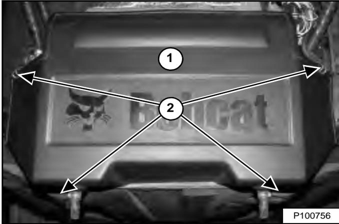
Ouvrez les attaches (2) et déposez le couvercle (1) [Figure 198].
