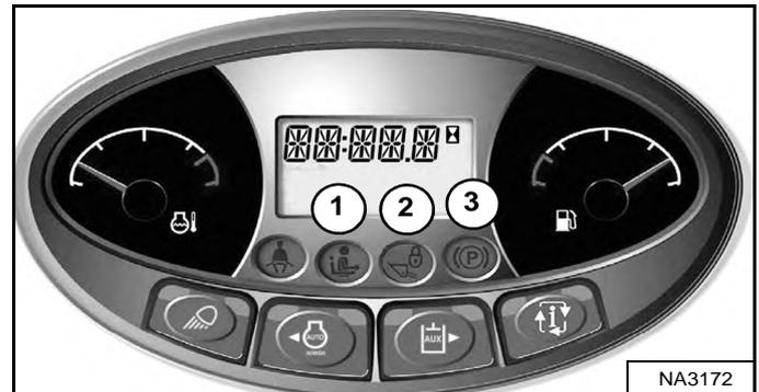
Les trois témoins (1, 2 et 3) [Figure 33] du tableau de bord gauche doivent être ÉTEINTS pour pouvoir utiliser la machine avec toutes ses fonctions.
