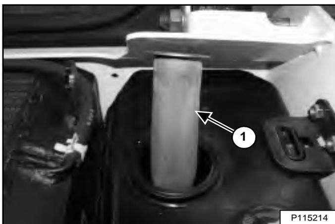
Déposez et nettoyez la crépine de remplissage d'huile hydraulique (1) [Figure 251]. Nettoyez la crépine avec de l'air à basse pression.
