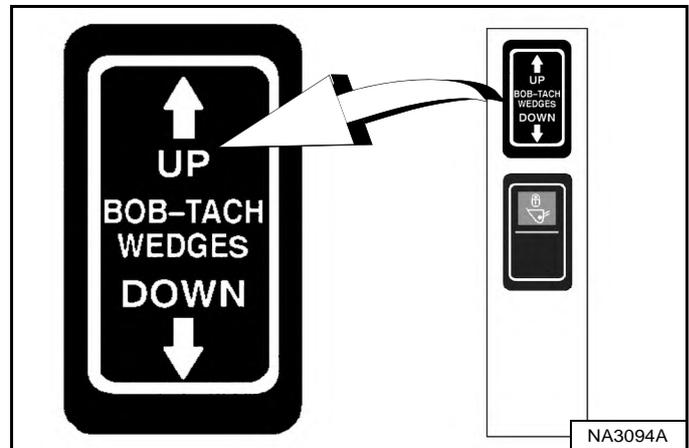
Appuyez sur le côté UP du contacteur « BOB-TACH WEDGES » (broches coniques vers le haut) (panneau des contacteurs droit) et maintenez-le enfoncé [Figure 137] jusqu'à ce que les leviers soient complètement relevés (broches coniques entièrement levées).
