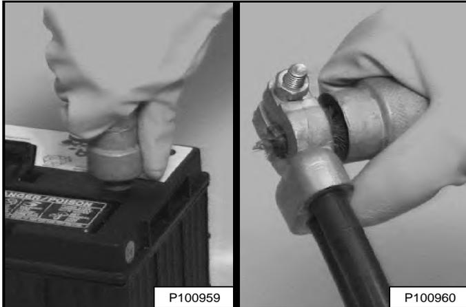
Les câbles de la batterie doivent être propres [Figure 236] et bien serrés.
