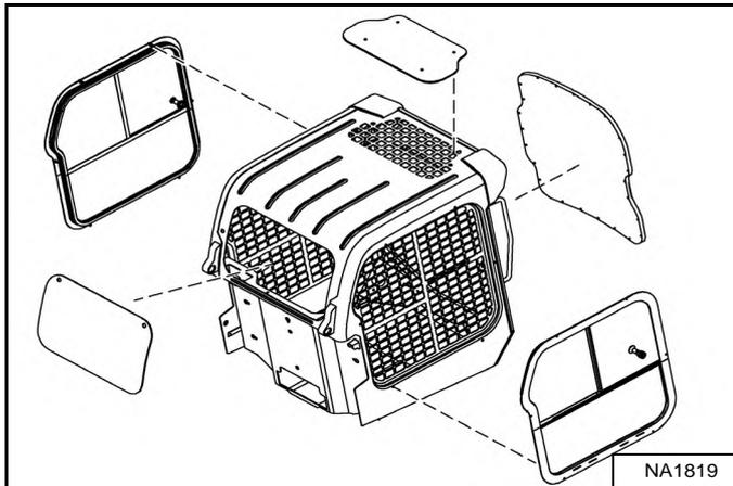
Destiné à éviter l'entrée de projections de débris et d'objets dans la cabine au cours de certains travaux. Ce kit comprend une vitre de porte avant, des vitres latérales et une vitre arrière de 19,1 mm (0,75") en polycarbonate feuilleté [Figure 6].
