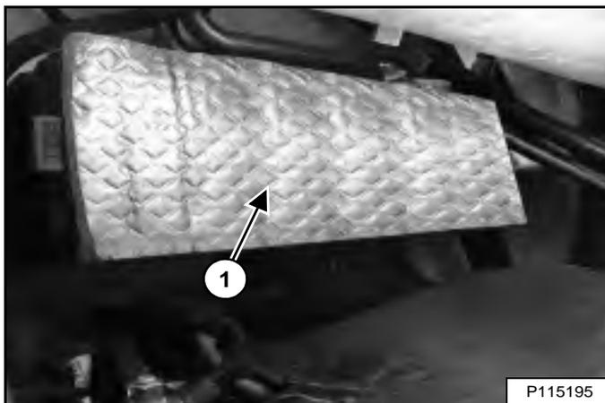
Le circuit électrique est protégé contre les surcharges par des fusibles situés sous le couvercle du boîtier de fusibles (1) [Figure 231]. Retirez le couvercle en le tirant par ses deux extrémités.
