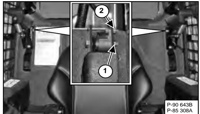
Éliminez les débris ou les saletés des points pivots à l'air comprimé. Ne lubrifiez pas. Contrôlez la visserie de fixation. Le couple de serrage correct de l'écrou d'articulation (des deux côtés) (1) est de 34 à 38 Nm (25 à 28 ft.-lb.). Le couple de l'écrou du capteur de l'arceau de siège (côté gauche uniquement) (2) [Figure 171] est de 6 à 8 Nm (50 à 70 in.-lb.).
