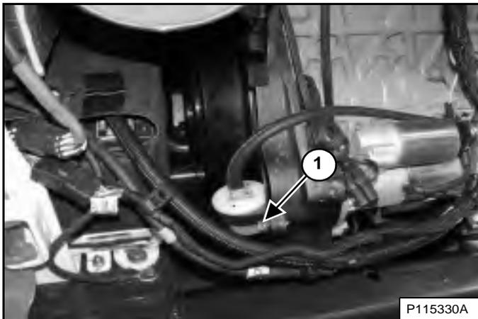
Déposez la vis du capot de la courroie d'entraînement (1) [Figure 275].
