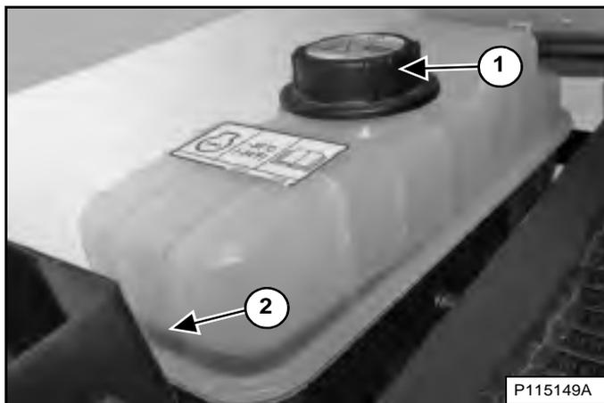
Déposez le bouchon de remplissage de liquide de refroidissement (1) [Figure 228].
