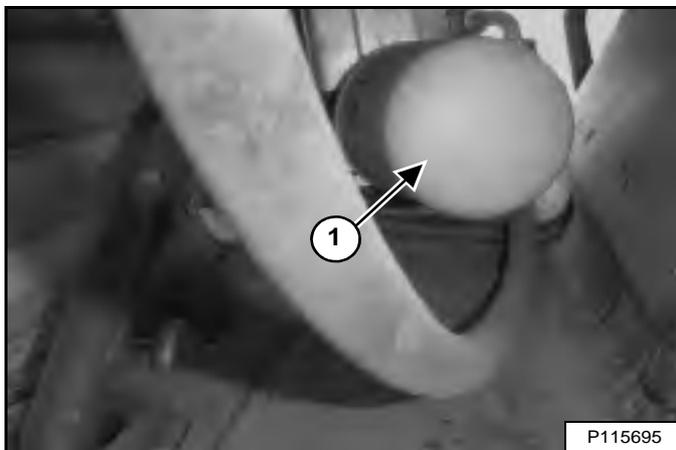
Placez un récipient approprié sous le filtre, déposez le filtre (1) [Figure 259] et nettoyez la base du filtre.
