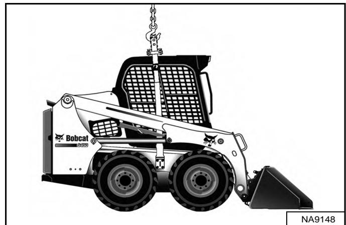
Fixez le crochet de levage au point de levage [Figure 164].
