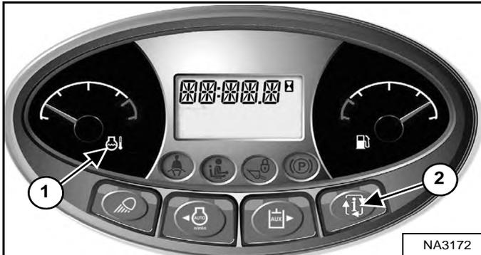
Contrôlez régulièrement les cadrans de température et de niveau de carburant ainsi que les témoins BICS™ (tous doivent être ÉTEINTS pour utiliser la chargeuse) [Figure 118].
