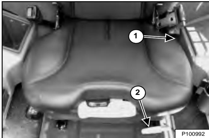
Levez le levier (1) [Figure 95] pour ajuster l'inclinaison du dossier du siège.
