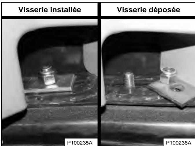
Déposez les écrous et les rondelles [Figure 187] (des deux côtés) aux coins avant de la cabine.
