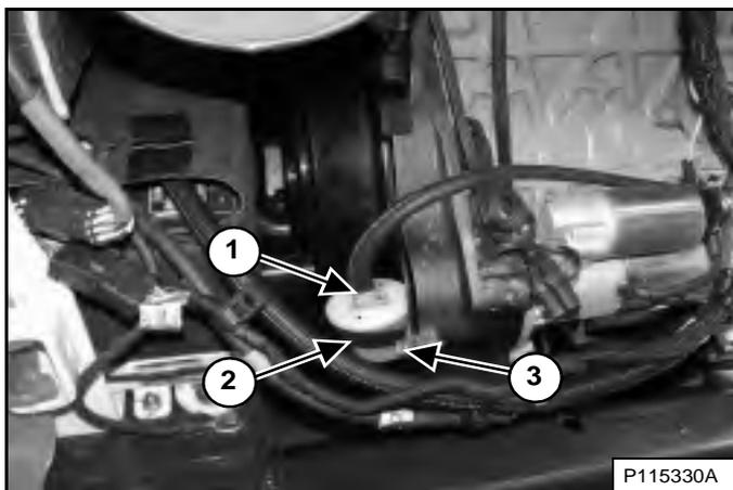
Desserrez la vis du capot de la courroie d'entraînement (3) [Figure 213].
