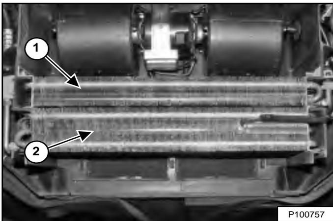
Nettoyez le faisceau de chauffage (1) et d'évaporation (2) avec de l'eau ou de l'air à basse pression pour retirer tous les débris [Figure 199].
