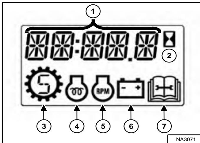
L'affichage est représenté en [Figure 13]. Au démarrage, l'affichage des données indique les heures de fonctionnement.
