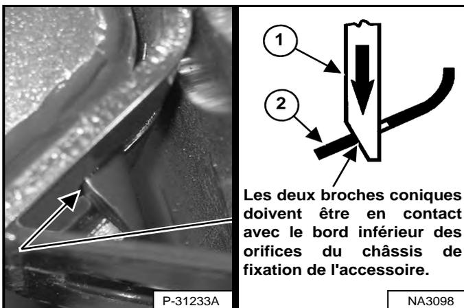
Les deux broches coniques doivent être en contact avec le bord inférieur des orifices du châssis de fixation de l'accessoire.
