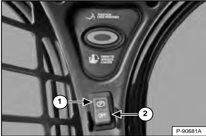
Enclenchez le frein de stationnement en appuyant sur le haut du contacteur (1) **[Figure 35]**. Le témoin rouge du contacteur s'ALLUME. La transmission est verrouillée.
