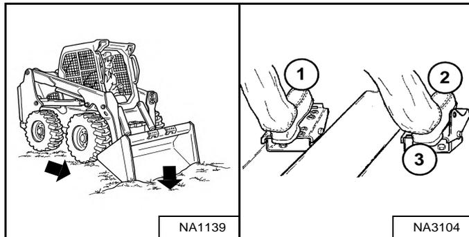
Abaissez complètement les bras de levage (1). Placez le bord d'attaque du godet sur le sol (2) [Figure 147].
