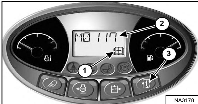
Remplacez les filtres à air uniquement lorsque cela s'avère nécessaire. Le témoin d'entretien (1) CLIGNOTE. Appuyez sur le bouton Information (3) jusqu'à ce que l'écran affiche les codes de service. Le code de service **[M0117]** (filtre à air colmaté) s'affiche (2) [Figure 205] lorsque le filtre doit être remplacé.
