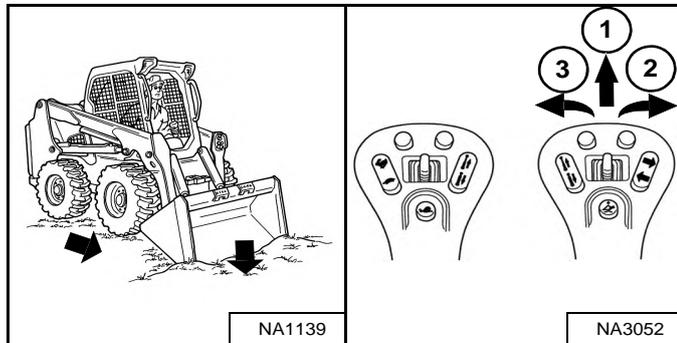
Abaissez complètement les bras de levage (1). Placez le bord d'attaque du godet sur le sol (2) **[Figure 161]**.
