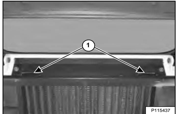
Le bord avant de la grille arrière comporte deux ergots qui s'emboîtent dans les logements présents sur le châssis de la chargeuse (1) [Figure 195]. Insérez les ergots dans les logements et abaissez la grille arrière.
