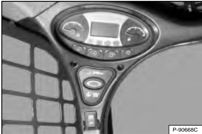
Le tableau de bord gauche [Figure 8] est décrit plus en détails (voir Tableau de bord gauche en page 46).
