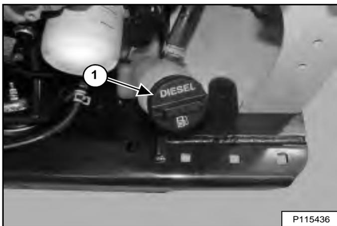
Retirer le bouchon du réservoir de carburant (1) [Figure 210].
