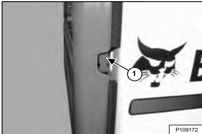
Passez la main dans l'encoche sur le côté droit de la porte arrière et tirez le loquet (1) [Figure 191]. Ouvrez la porte arrière en tirant dessus.
