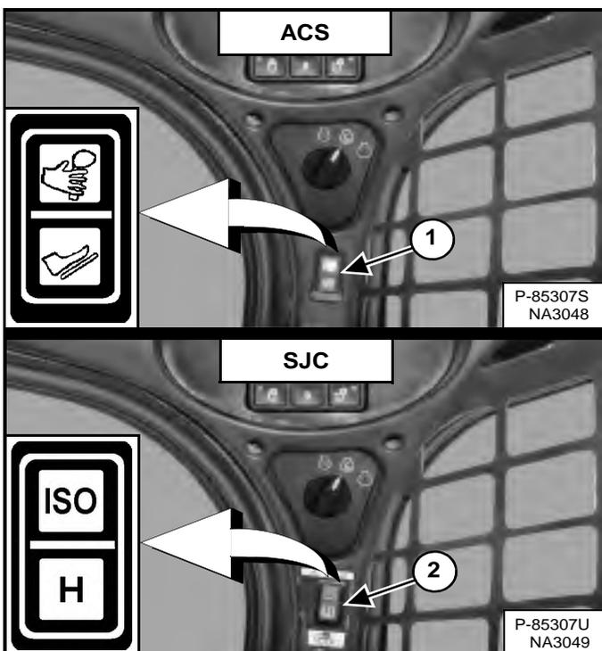
**(ACS)** Sélectionnez le fonctionnement par commandes manuelles ou par pédales (1) [Figure 111] si la machine est équipée de commandes ACS.
