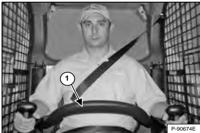
Le dispositif de verrouillage Bobcat (BICS™) comprend un arceau de siège pivotant avec accoudoirs (1) [Figure 32]. L'utilisation de l'arceau de siège est commandée par l'opérateur.
