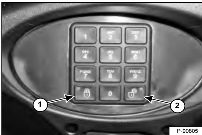
Enfoncez et maintenez les boutons de verrouillage (1) et de déverrouillage (2) [Figure 299] pendant 2 secondes.
