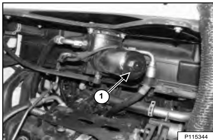
Placez un récipient approprié sous le logement du filtre et retirez le logement (1) [Figure 256].
