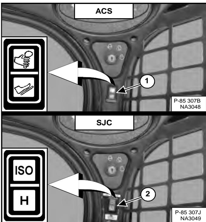
(ACS) Sélectionnez le fonctionnement par commandes manuelles ou par pédales (1) [Figure 106] si la machine est équipée de commandes ACS.
