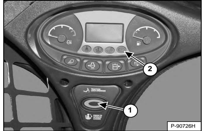
(Fonctionne uniquement lorsque l'arceau de siège est relevé et que le moteur tourne). La commande de déverrouillage de la transmission (TRACTION LOCK OVERRIDE) (1) **[Figure 36]** se trouve sur le tableau de bord gauche. Elle permet de déplacer la chargeuse en marche avant ou arrière à l'aide des commandes de direction en cas d'utilisation de la pelle rétro.
