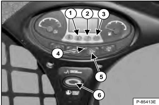
1. Installez-vous dans le siège de l'opérateur. Tournez le contacteur à clé sur la position MARCHE. Abaissez l'arceau de siège et libérez le frein de stationnement. Appuyez sur le bouton PRESS TO OPERATE LOADER (6). Les deux témoins BICS™ (1 et 2) [Figure 169] [ARCEAU DE SIÈGE et LEVAGE ET CAVAGE] du tableau de bord gauche doivent être ÉTEINTS. Le bouton PRESS TO OPERATE LOADER s'allume.
