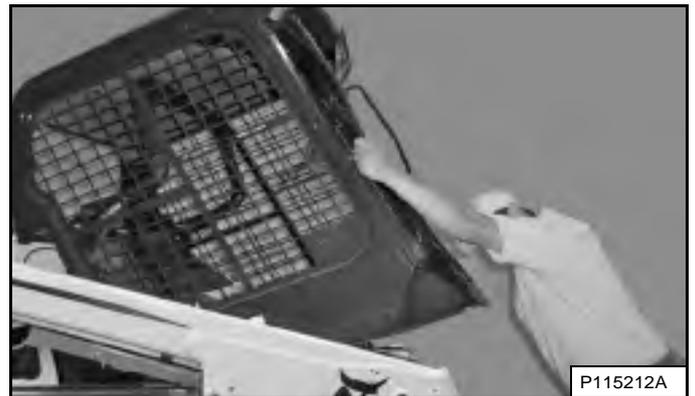
Levez lentement la cabine de l'opérateur par les mains courantes et le bas de la cabine jusqu'à ce qu'elle soit complètement levée et que son mécanisme de verrouillage s'enclenche [Figure 188].
