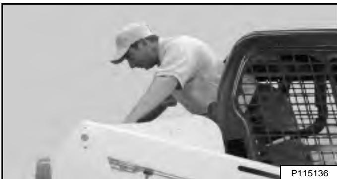
Sortez de la chargeuse par l'arrière de la cabine [Figure 42].
