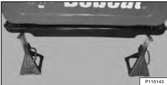
Placez des chandelles sous les coins arrière du châssis de la chargeuse [Figure 186].
