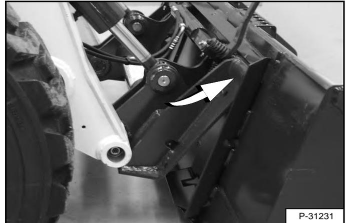
Avancez lentement la chargeuse jusqu'à ce que le bord supérieur du Bob-Tach soit complètement sous le gousset supérieur du châssis de fixation du godet [Figure 132] (ou autre accessoire).
