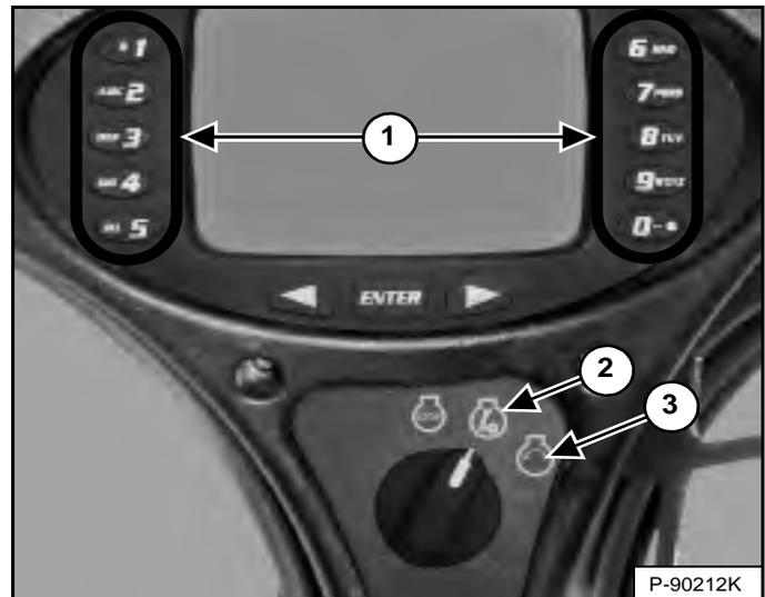
Tournez le contacteur à clé sur la position RUN (Marche) (2) [Figure 114]. Les témoins du tableau de bord gauche s'ALLUMENT brièvement tandis que le tableau de bord/système de surveillance exécute un test automatique.
