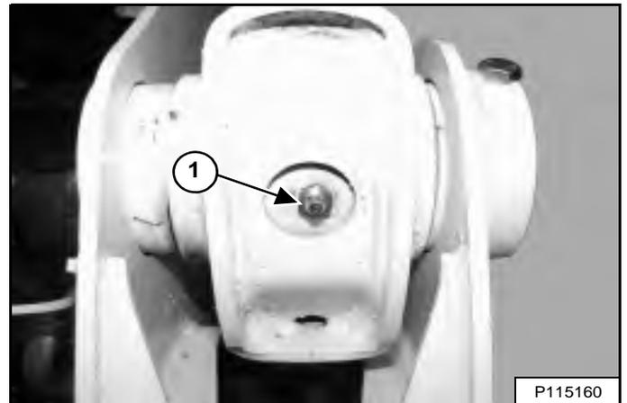
1. Axe pivot des bras de levage (des deux côtés) (2) [Figure 281].
