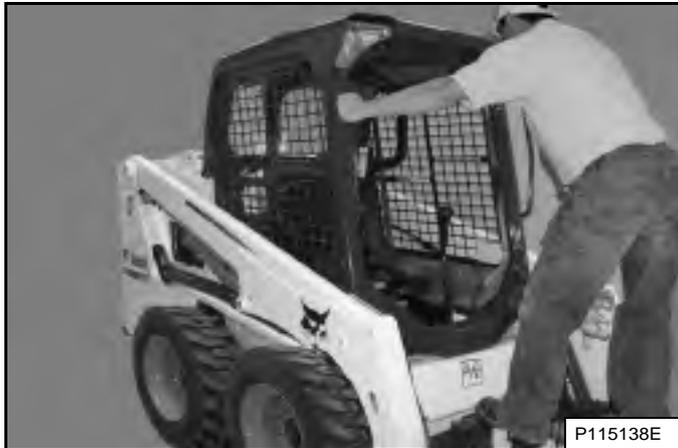
Utilisez les marchepieds du godet ou de l'accessoire, les mains courantes et l'antidérapant (sur les bras de levage et le châssis de la chargeuse) pour monter et descendre de la chargeuse en maintenant en permanence un contact en trois points [Figure 93]. Ne sautez pas.
