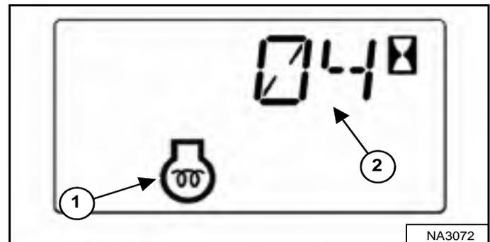
Si la température est basse, les bougies de préchauffage s'allument automatiquement. L'icône du préchauffage du moteur (1) s'ALLUME et le temps de préchauffage est décompté sur l'affichage des données (2) [Figure 105].
