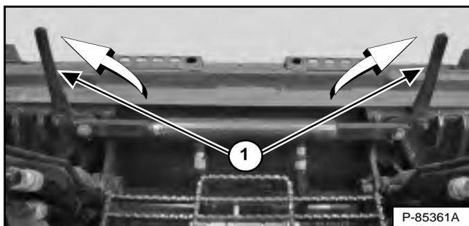
Appuyez sur le côté UP du contacteur « BOB-TACH WEDGES » (broches coniques vers le haut) (panneau des contacteurs droit) et maintenez-le enfoncé [Figure 130] jusqu'à ce que les leviers (1) [Figure 131] soient complètement relevés (broches coniques entièrement levées).
