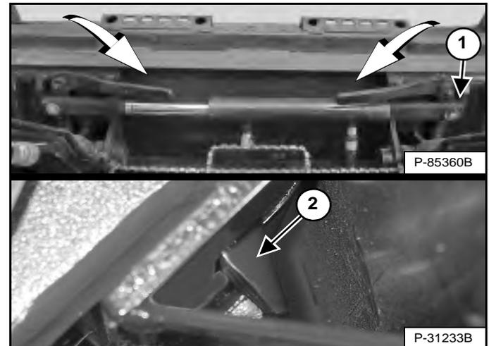
Appuyez sur le côté DOWN du contacteur « BOB-TACH WEDGES » (broches coniques vers le bas) (panneau des contacteurs droit) et maintenez-le enfoncé [Figure 135] jusqu'à ce que les leviers soit totalement engagés en position verrouillée [Figure 136] (broches coniques complètement engagées dans les orifices du châssis de fixation de l'accessoire).
