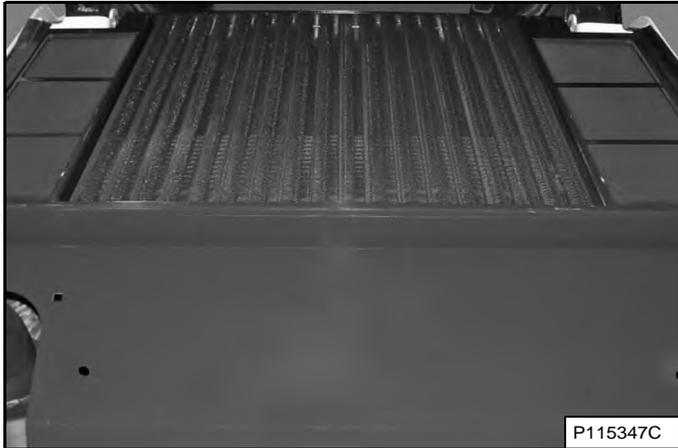
Soulevez la grille arrière et tirez-la vers l'arrière pour la retirer de la chargeuse [Figure 194].
