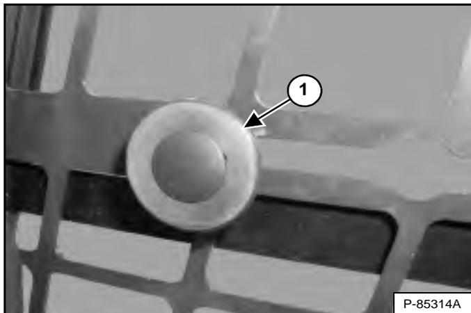
Tirez le bouton (1) [Figure 26] et ouvrez la vitre en la faisant coulisser vers l'arrière. Relâchez le bouton au niveau de la découpe pour verrouiller la vitre dans la position voulue. Tirez le bouton et faites coulisser la vitre vers l'avant pour la fermer.
