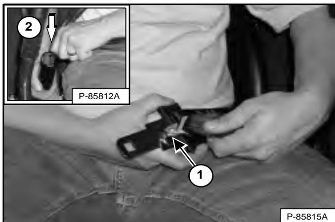
**REMARQUE :** le système de retenue à 3 points doit être utilisé lorsque vous sélectionnez la grande vitesse [Figure 62].
