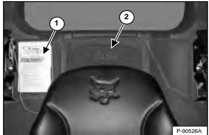
Lisez et comprenez le contenu du Manuel de l'Opérateur et d'Entretien et du Guide de l'Opérateur (1) [Figure 94] avant d'utiliser la chargeuse.
