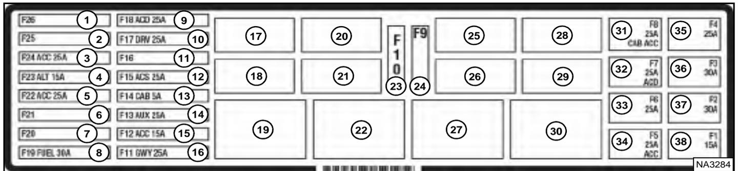
Le tableau ci-dessous correspond aux modèles récents n'ayant pas de relais en position 25 et 28. Les emplacements et les ampérages des fusibles sont indiqués dans le tableau ci-dessous et sur l'autocollant [Figure 235]. Les relais sont identifiés par la lettre « R » dans la colonne AMP.
