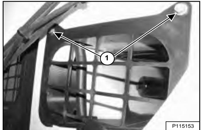
Déposez les boulons (1) du capot d'accès gauche [Figure 271] et retirez le capot
