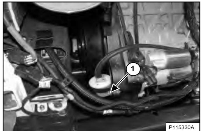
Serrez la vis (1) du capot de la courroie d'entraînement [Figure 279].
