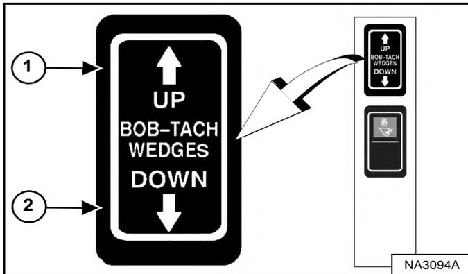
Enfoncez et maintenez le côté UP du contacteur BOB-TACH WEDGES (broches coniques vers le haut) (1) jusqu'à ce que les broches coniques soient complètement relevées. Enfoncez et maintenez le côté DOWN du contacteur BOB-TACH WEDGES (broches coniques vers le bas) (2) [Figure 293] jusqu'à ce que les broches coniques soient complètement abaissées.
