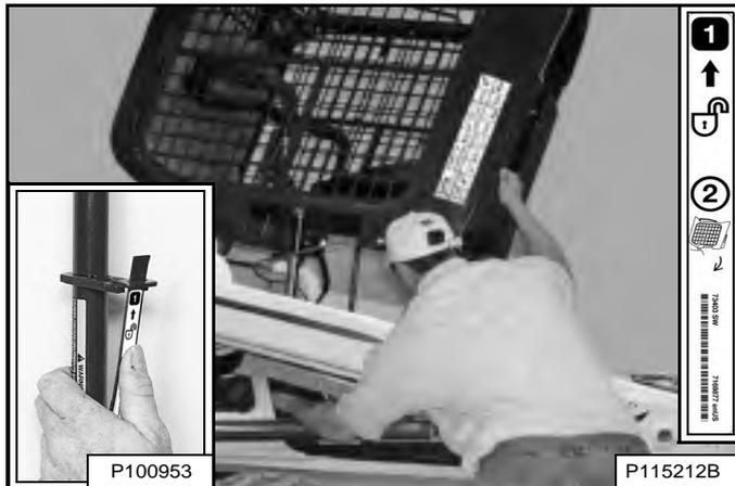
Tirez vers le bas la partie inférieure de la cabine jusqu'à ce qu'elle se cale sur le mécanisme de verrouillage [Figure 189].
