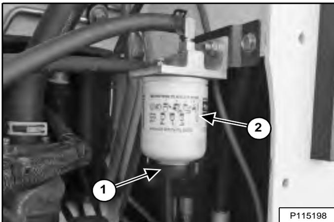
Desserrez le purgeur (1) [Figure 212] situé au bas du filtre pour vidanger l'eau emprisonnée dans le filtre.
