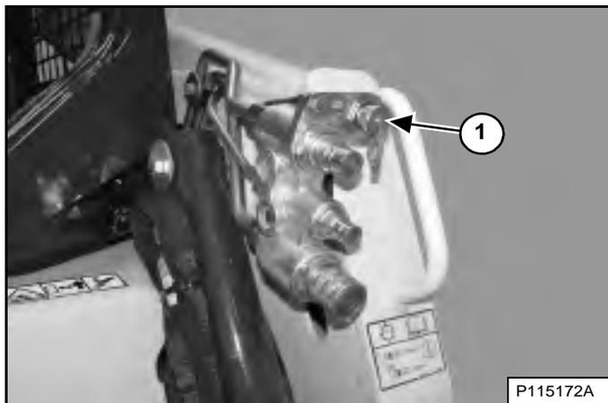
Connectez le faisceau électrique de l'accessoire au module d'identification des accessoires (1) [Figure 88].
