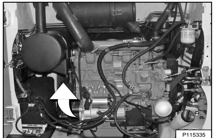
Le compresseur de climatisation se trouve derrière le moteur, sur le côté gauche de la chargeuse [Figure 272].
