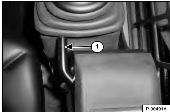
Tirez le levier de réglage (1) [Figure 102] des manipulateurs vers le haut pour faire glisser les manipulateurs vers l'avant ou l'arrière afin de les placer dans la position la plus confortable (côté droit illustré).
