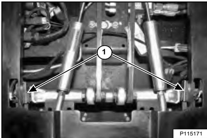
Les contacteurs de l'alarme de recul (1) [Figure 182] sont situés contre les leviers de direction. Les deux contacteurs doivent être correctement réglés pour que l'alarme de recul fonctionne convenablement.
