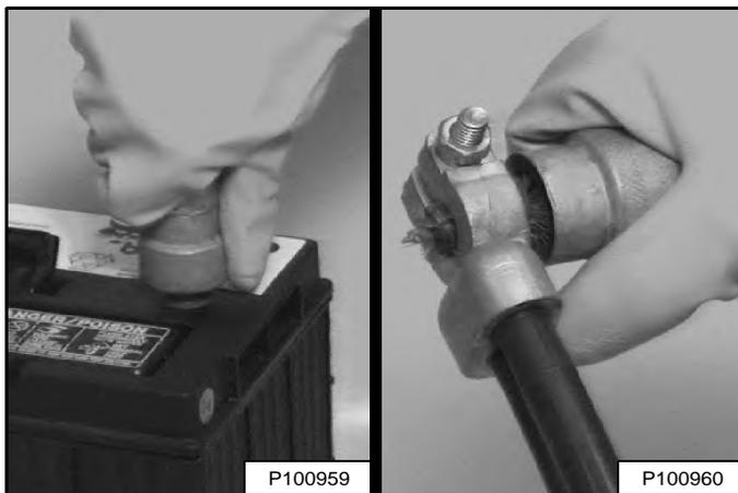
Nettoyez toujours les bornes et les extrémités des câbles lors de l'installation d'une batterie neuve ou usagée [Figure 241].
