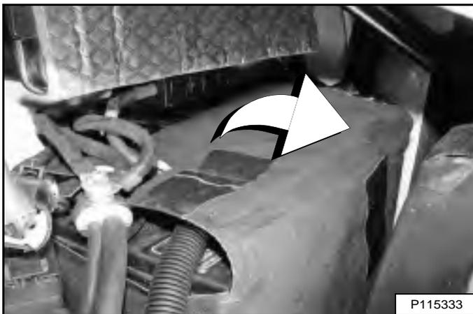
Ouvrez le rabat supérieur de la sacoche de la batterie pour accéder aux bornes de la batterie [Figure 238].
