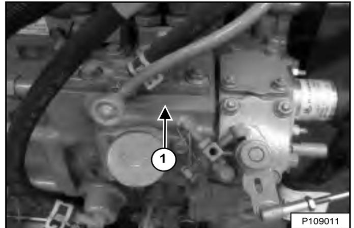
Le numéro de série du moteur (1) [Figure 3] est situé au-dessus du bouchon de remplissage d'huile.
