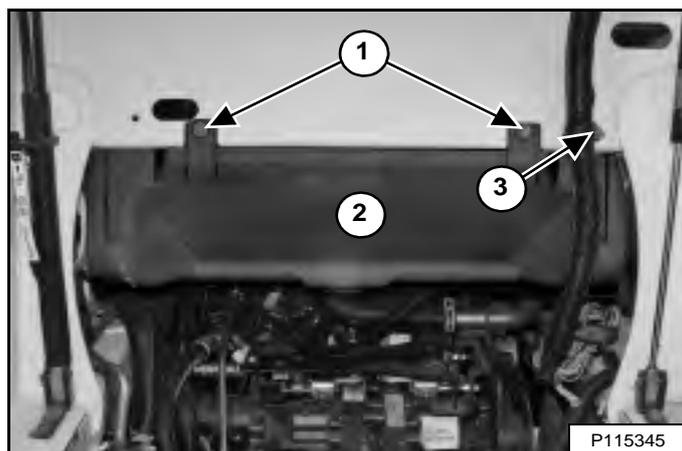
Retirez l'écrou (3) qui retient la bride du faisceau électrique de la cabine et amenez le faisceau vers l'avant de la chargeuse. Déposez les boulons (1) et le carénage inférieur du ventilateur (2) [Figure 255].
