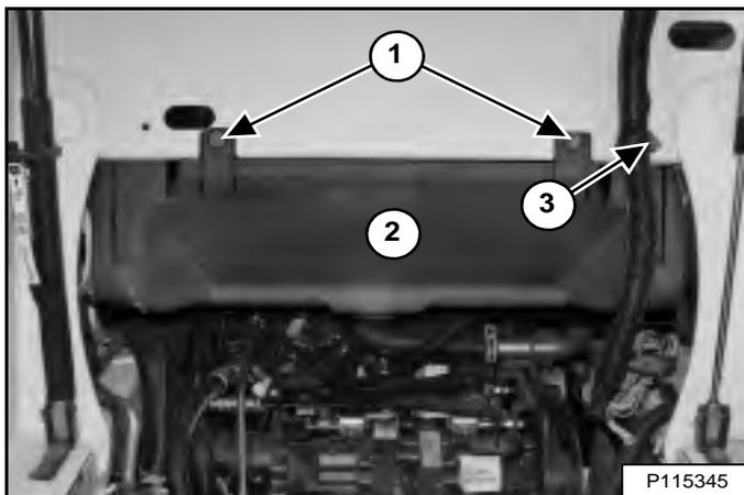
Retirez l'écrou (3) qui retient la bride du faisceau électrique de la cabine et amenez le faisceau vers l'avant de la chargeuse. Déposez les boulons (1) et le carénage inférieur du ventilateur (2) [Figure 270].
