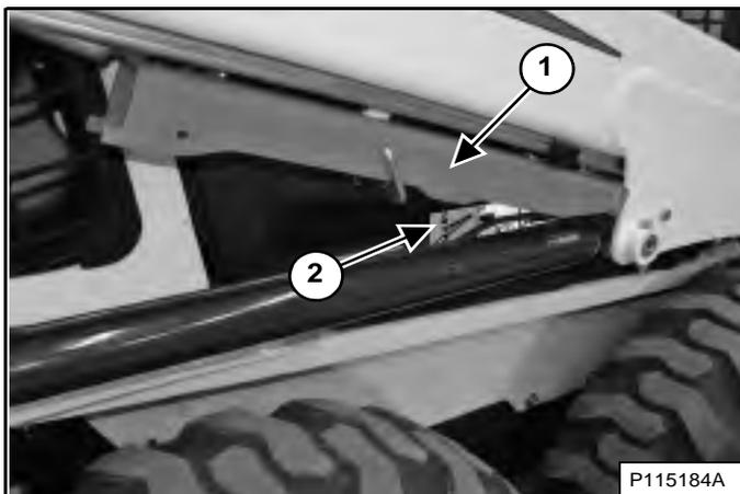
L'arrêt de bras de levage (1) [Figure 173] sert à maintenir les bras de levage pour travailler sur une machine dont les bras sont relevés.
