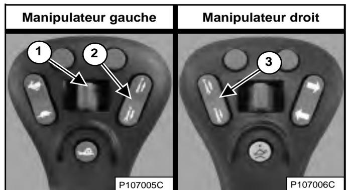
Des contacteurs supplémentaires (1, 2 et 3) [Figure 90] ou [Figure 91] sont utilisés pour commander certaines fonctions des accessoires par l'intermédiaire du module d'identification des accessoires.
