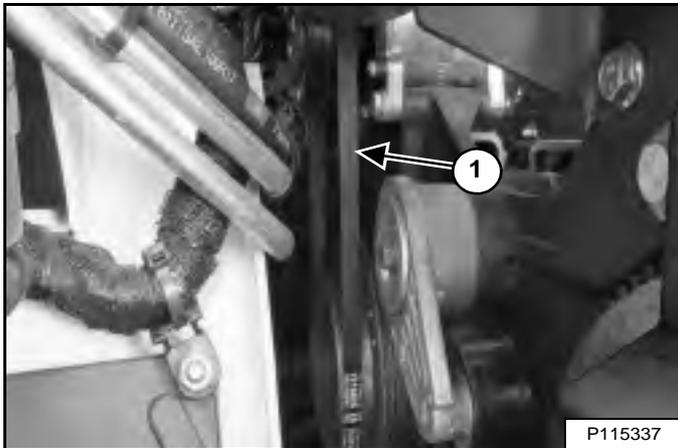
Coupez la courroie usagée (1) [Figure 273] et déposez-la des poulies. Contrôlez l'usure des poulies.
