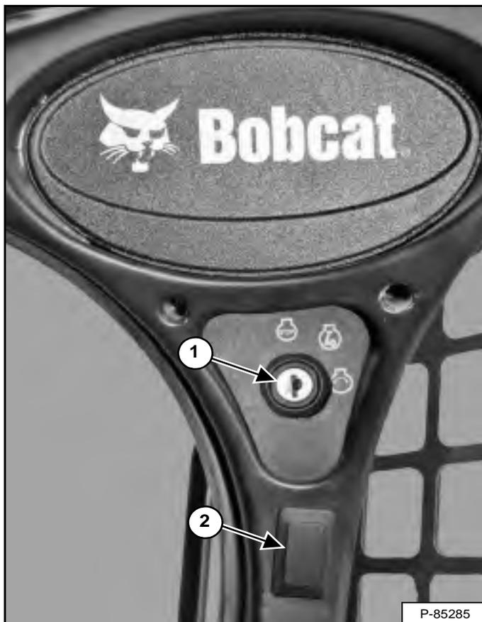
Cette machine peut être équipée d'un tableau standard à contacteur à clé [Figure 14].
