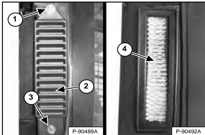
Les filtres d'air frais se trouvent derrière les vitres latérales, à l'extérieur de la cabine (côté droit représenté). Déposez la vis de blocage (3) et le couvercle du filtre (2) [Figure 196]. (les bras de levage sont représentés levés pour plus de clarté).
