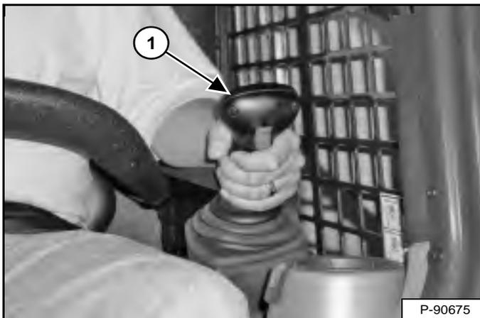
Le manipulateur qui commande la translation et la direction se trouve à gauche à l'avant du siège (1) [Figure 57].
