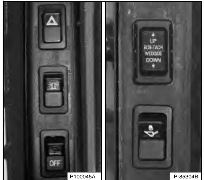
Les panneaux de contacteurs gauche et droit [Figure 10] sont décrits plus en détail (voir Tableau des contacteurs gauche en page 53) et (voir Tableau des contacteurs droit en page 53).
