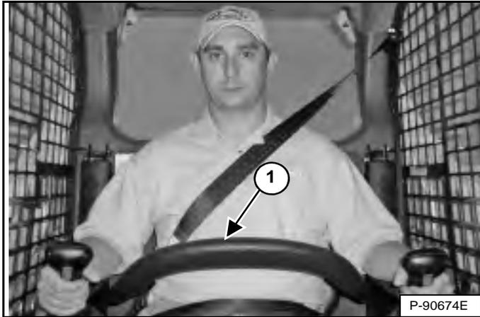
Le dispositif de sécurité de l'arceau de siège comprend un arceau de siège pivotant avec accoudoirs (1) [Figure 170].
