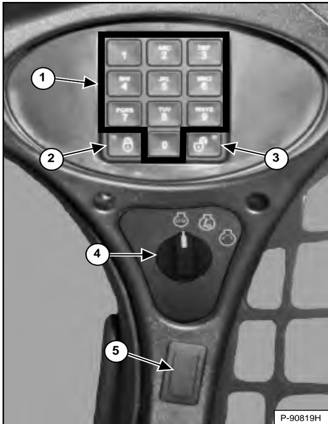
Cette machine peut être équipée d'un tableau à démarrage sans clé [Figure 15].
