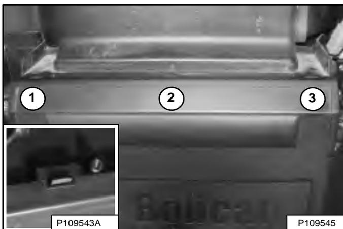
2. Poussez le capot vers le haut aux trois emplacements indiqués (1, 2 et 3) jusqu'à ce que les logements s'emboîtent sur les ergots. Ce logement (médaillon) [Figure 203] est correctement fixé.
