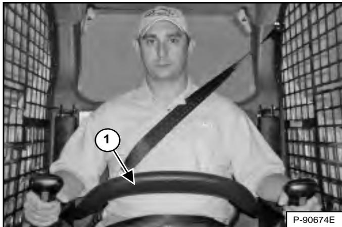
Le dispositif de sécurité de l'arceau de siège comprend un arceau de siège pivotant avec accoudoirs (1) [Figure 34].
