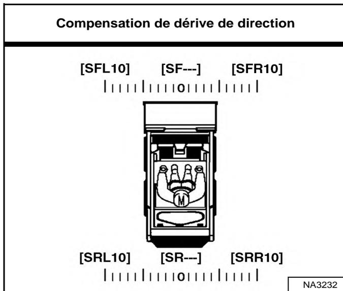
La compensation de dérive de direction comprend au total 21 réglages. La compensation de dérive de direction peut être réglée sur n'importe quelle valeur du point neutre à [SFL10] ou [SRL10] à gauche, et du point neutre à [SFR10] ou [SRR10] à droite. [SF---] ou [SR---] s'affiche lorsqu'elle est réglée sur le point neutre [Figure 69].
