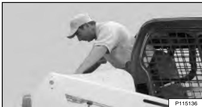
Sortez de la chargeuse par l'arrière de la cabine [Figure 44].
