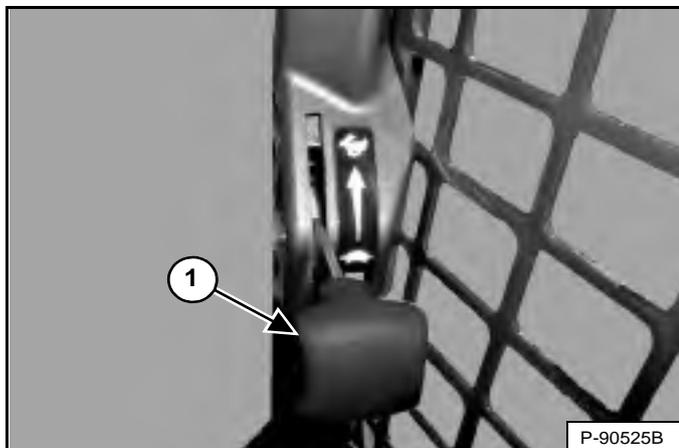
La commande d'accélérateur (1) [Figure 37] se trouve sur le montant de la porte, sous le tableau de bord droit.
