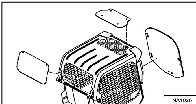
Destiné à éviter la pénétration de débris par les ouvertures de la cabine au cours de certains travaux. Ce kit comprend une vitre de porte avant et une vitre arrière de 12,7 mm (0,5") en polycarbonate **[Figure 5]**.
