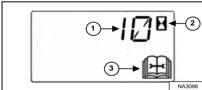
Pendant l'utilisation de la machine, une alarme à 2 signaux sonores retentit lorsqu'il reste moins de 10 heures jusqu'au prochain entretien périodique.
