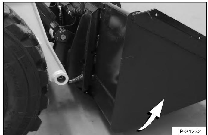
Inclinez le Bob-Tach vers l'arrière jusqu'à ce que le bord d'attaque du godet (ou autre accessoire) se trouve légèrement au-dessus du sol [Figure 133]. Cette procédure permet au châssis de fixation du godet de se plaquer contre l'avant du Bob-Tach.
