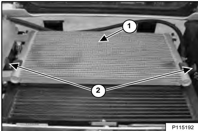
Nettoyez le haut du condenseur de climatisation (1) avec de l'air ou de l'eau à basse pression [Figure 223].
