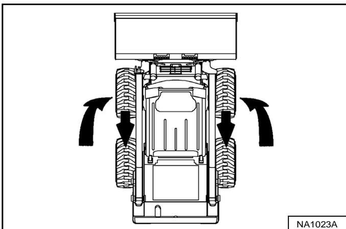
Les pneus arrière s'usent généralement plus vite que les pneus avant. Pour maintenir une usure uniforme, permutez les pneus avant et arrière [Figure 263].
