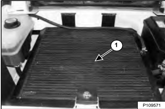
Nettoyez le dessus de l'ensemble refroidisseur d'huile hydraulique et radiateur avec de l'air ou de l'eau à basse pression (1) **[Figure 226]**.
