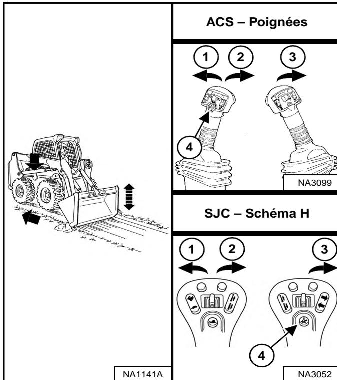
Appuyez sur le bouton de flottement (4) et maintenez-le enfoncé quand la poignée ou le manipulateur est au point mort. Relâchez le bouton de flottement tout en abaissant les bras de levage (2) **[Figure 153]**.
