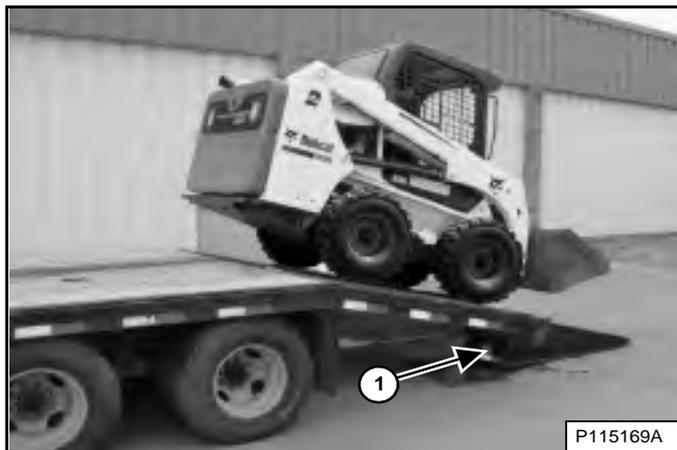
Faites monter la chargeuse en marche arrière sur le véhicule de transport si le godet est vide, ou si l'accessoire a été déposé [Figure 167].
