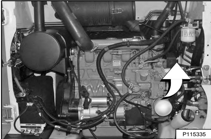
L'alternateur se trouve derrière le moteur, sur le côté droit de la chargeuse [Figure 266].
