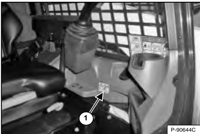
Assurez-vous que l'autocollant de l'alarme de recul (1) [Figure 180] n'est ni endommagé ni manquant. Remplacez-le si nécessaire.
