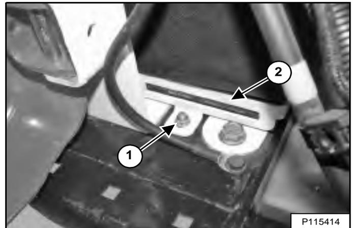
Installez la bride de la batterie (2) et l'écrou (1) [Figure 242].
