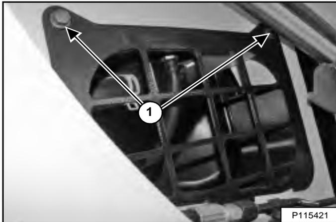
Déposez les boulons (1) du capot d'accès droit [Figure 258] et retirez le capot
