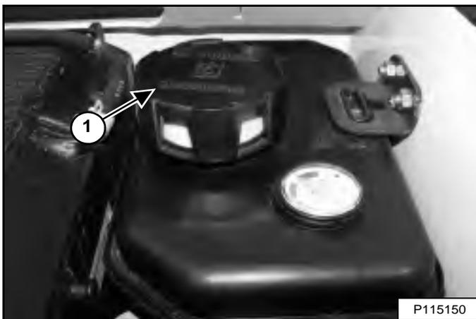
Déposez le bouchon de remplissage (1) [Figure 246].
