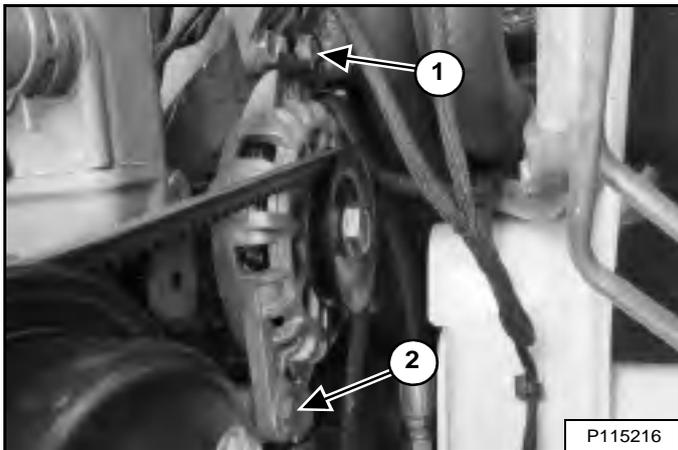
Desserrez le boulon de réglage supérieur de l'alternateur (1). Desserrez le boulon de fixation inférieur de l'alternateur (2) [Figure 267].
