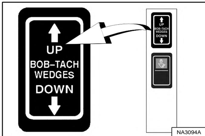
Appuyez sur le côté UP du contacteur « BOB-TACH WEDGES » (broches coniques vers le haut) (panneau des contacteurs droit) et maintenez-le enfoncé [Figure 134] pour vous assurer que les leviers sont complètement relevés (broches coniques entièrement levées).
