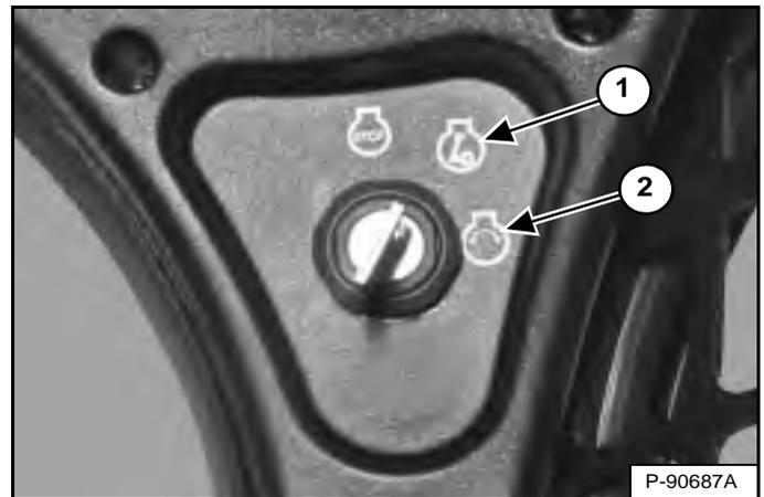
Tournez le contacteur à clé sur la position RUN (Marche) (1) [Figure 104]. Les témoins du tableau de bord gauche s'ALLUMENT brièvement tandis que le tableau de bord/système de surveillance exécute un test automatique.
