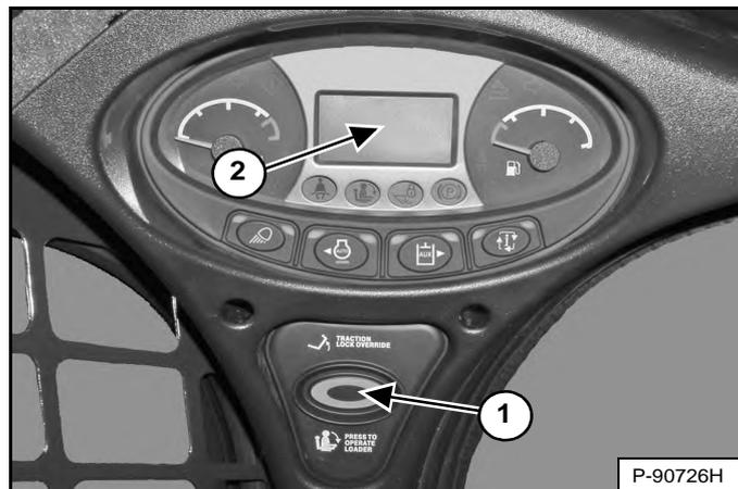
Enfoncez le bouton **PRESS TO OPERATE LOADER** (1) [Figure 107] pour activer le système BICS™ et les fonctions hydrauliques de la chargeuse.
