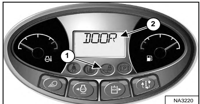
Le témoin de LEVAGE ET CAVAGE (1) [Figure 185] est ÉTEINT lorsque la porte est fermée, que le contacteur à clé est placé sur la position MARCHÉ, que l'arceau de siège est abaissé et que le bouton PRESS TO OPERATE LOADER est enfoncé.
