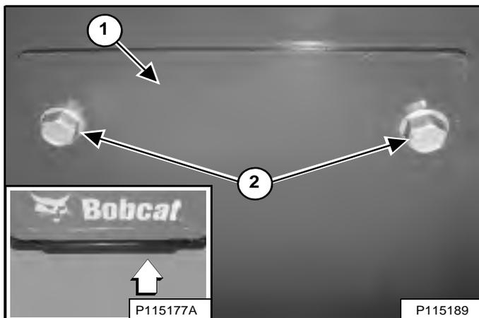
Le flexible de vidange d'huile est situé derrière un capot (1) sous l'arrière de la chargeuse (médaillon) [Figure 218].
