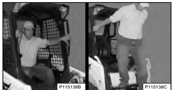
Sortez de la chargeuse en utilisant les mains courantes, les antidérapants et les marchepieds (en maintenant un contact en trois points) [Figure 121].
