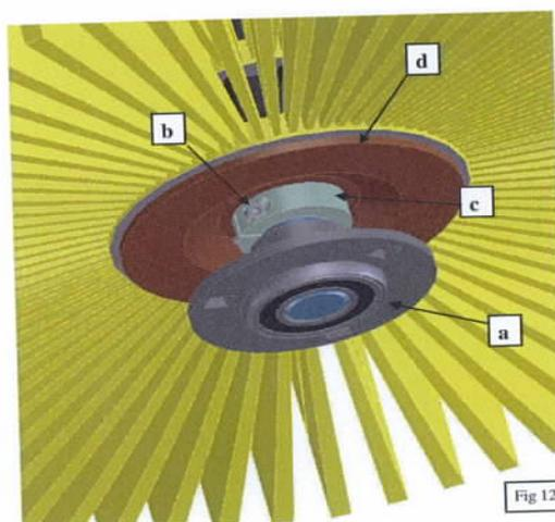
Retirez le roulement (Fig 12-a) à côté du pignon d'entraînement.
