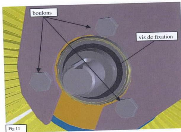
Dévissez les 3 boulons des roulements et retirez-les. (Fig 11)
